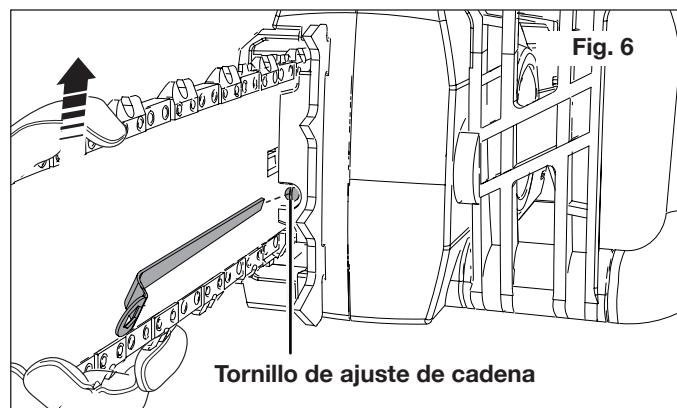
3. Vuelva a apretar las tuercas de cubierta de extremo. Usando un destornillador, haga avanzar la cadena a lo largo de la guía para comprobar que se mueva con facilidad.
