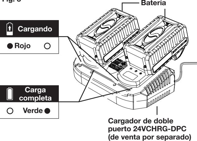
3. Las luces LED indicadoras de la batería se iluminarán una a una durante el proceso de carga. Desconecte el cargador inmediatamente cuando las tres luces LED estén iluminadas.
