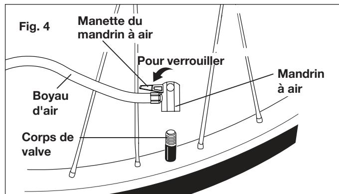
4. Pour retirer le mandrin à air, levez la manette de serrage et dégarez-le du corps de valve (Fig. 5).
