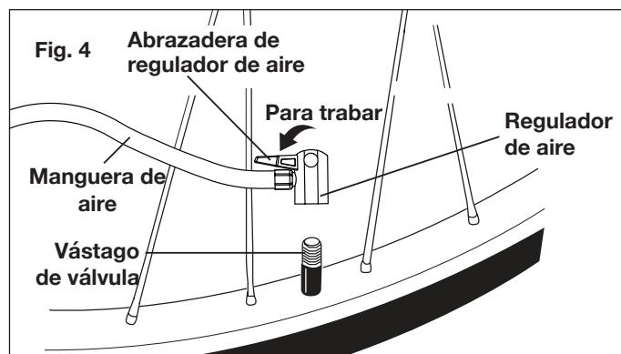
4. Para retirar, levante la abrazadera del regulador de aire y desconecte el regulador de aire del vástago de válvula (Fig. 5).
