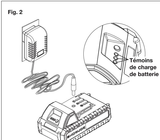
3. Il faut environ cinq heures pour charger la batterie. Les témoins de charge de batterie scintilleront et s'allumeront un par un pendant le processus de charge. Débranchez immédiatement l'adaptateur de charge lorsque les témoins de charge sont tous les trois allumés.
