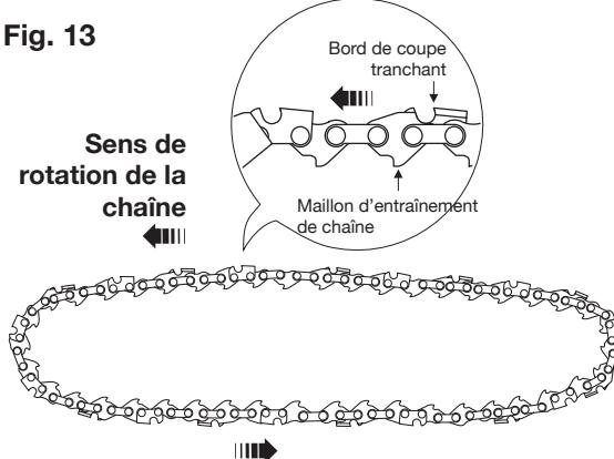
5. En commençant par l'embout, montez les maillons d'entraînement dans la rainure du guide-chaîne en formant une boucle à l'arrière de celui-ci. La chaîne s'ajustera en restant lâche jusqu'à ce qu'elle soit placée sur le pignon (Fig. 14).
