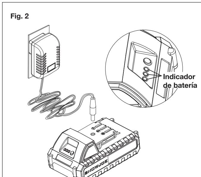
3. La batería tomará aproximadamente cinco horas en cargarse. Las luces LED indicadoras de la batería parpadearán y se iluminarán una a una durante el proceso de carga. Desconecte el cargador inmediatamente cuando las tres luces LED estén encendidas.
