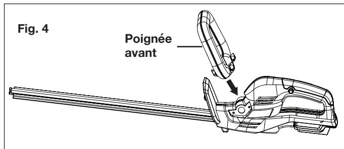
2. Attachez la poignée avant sur l'outil à l'aide des quatre vis prévues à cet effet (Fig. 5). Lorsque les vis sont bien vissées, votre taille-haie est prêt à être utilisé.
