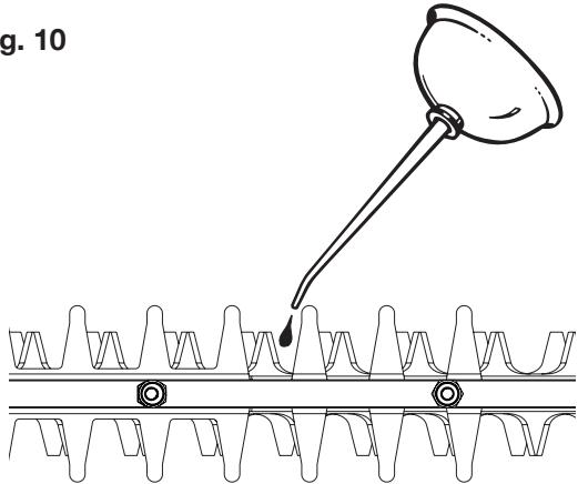
Si va a usar la bordeadora de arbustos por un periodo prolongado, se recomienda detener el trabajo de forma intermitente para re-aceitar las cuchillas.
