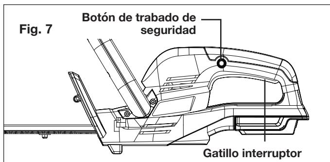
3. Para apagar la herramienta, suelte el gatillo interruptor y el botón de trabado de seguridad (Fig. 7).
