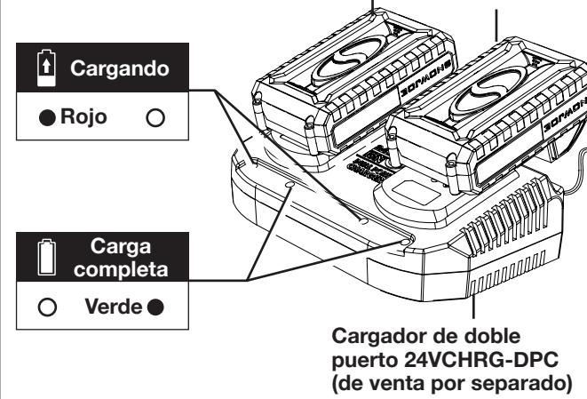
3. Las luces LED indicadoras de la batería se iluminarán una a una durante el proceso de carga. Desconecte el cargador inmediatamente cuando las tres luces LED estén iluminadas.
