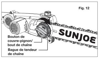
2. La tension est la bonne si les maillons d'entraînement sur la chaîne ne glissent pas hors des guides de chaîne sur le guide-chaîne lorsque vous tirez la chaîne au milieu du guide-chaîne (Fig. 13).
