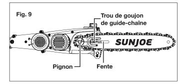
7. Replacez le couvre-pignon/bout de chaîne en le positionnant sur la tête porte-scie. Placer le bouton du couvre-pignon/bout de chaîne en insérant le goujon de guide-chaîne dans le trou de goujon de guide-chaîne. Serrez le bouton du couvre-pignon/bout de chaîne, mais laissez le guide-chaîne se déplacer librement pour le réglage de la tension (Fig. 10).
