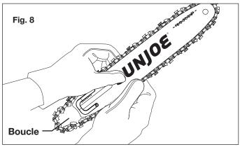
6. Maintenez la chaîne en position sur le guide-chaîne et enroulez la boucle autour du pignon. Placez le guidechaîne de manière à ce qu'il repose bien contre la surface de fixation et que le trou du goujon du guide-chaîne soit aligné avec la longue fente du guide-chaîne (Fig. 9).
