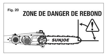
AVERTISSEMENT! Un effet de rebond peut se produire quand la chaîne en mouvement entre en contact avec un objet au niveau de la partie supérieure de l'embout du guide-chaîne ou quand le bois se rapproche trop près et pince la scie à chaîne dans l'entaille (Fig. 20). Tout contact au niveau de la partie supérieure de l'embout du guide-chaîne
