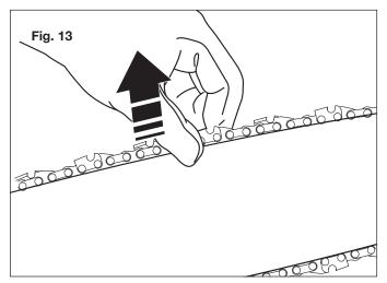
**REMARQUE:** si la chaîne est trop serrée, elle ne tournera pas. Desserrez légèrement le bouton de couvre-pignon/bout de chaîne et tournez le bouton de tension de chaîne d'un quart (1/4) de tour dans le sens antihoraire. Levez l'embout du guide-chaîne et serrez à nouveau le bouton de couvre-pignon/bout de chaîne. Assurez-vous qu'il est possible de faire tourner la chaîne à la main sans qu'elle se grippe.
