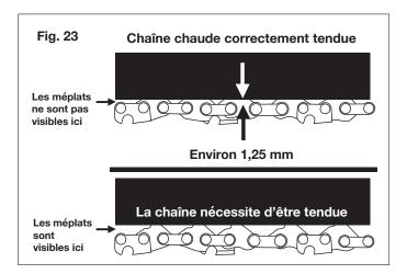
**REMARQUE :** une chaîne neuve a tendance à s'étirer. Vérifiez fréquemment la tension de la chaîne et, au besoin, tendez-la à nouveau.
