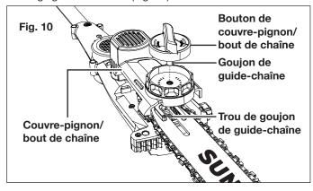
8. Éliminez complètement le jeu de la chaîne en tournant la bague du tendeur de chaîne dans le sens horaire jusqu'à ce que la chaîne repose parfaitement contre le guidechaîne, les maillons d'entraînement étant dans la rainure du guide-chaîne (Fig. 11).
