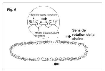
5. En commençant par l'embout, montez les maillons d'entraînement dans la rainure du guide-chaîne en formant une boucle à l'arrière de celui-ci. La chaîne s'ajustera en restant lâche jusqu'à ce qu'elle soit placée sur le pignon (Fig. 7 et 8).
