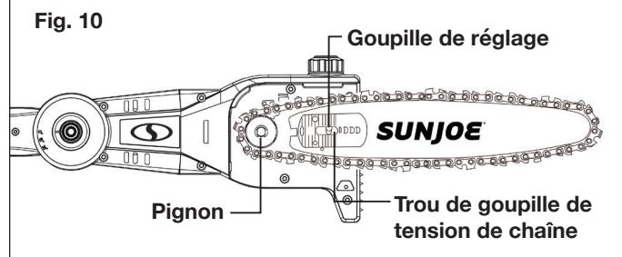
8. Replacez la coiffe arrière de chaîne/pignon en la positionnant sur la tête porte-scie. Serrez le bouton de coiffe arrière, mais laissez le guide-chaîne se déplacer librement pour le réglage de la tension. Posez le boulon à tête hexagonale en le vissant dans le sens des aiguilles d'une montre à l'aide de la clé hexagonale.
