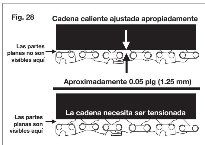
**NOTA:** una cadena nueva tiende a estirarse. Compruebe la tensión de cadena y re-tensione según se necesite.
