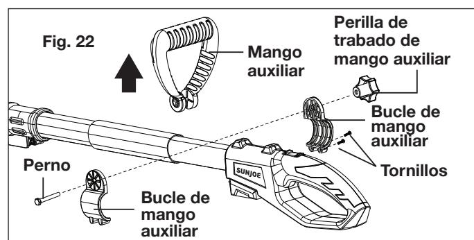
3. Reensamble los bucles de mango auxiliar en la posición deseada del tubo usando los dos tornillos, y vuelva a colocar el mango auxiliar, la perilla de trabado de mango auxiliar y el perno (Fig. 22).
