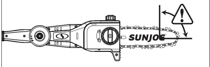
**⚠ ¡ADVERTENCIA!** Un contragolpe puede ocurrir cuando la cadena en movimiento hace contacto con un objeto en la parte superior de la punta de la barra-guía, o cuando la madera se cierra apretando la motosierra durante el corte (Fig. 25). El contacto en la parte superior de la punta de la
