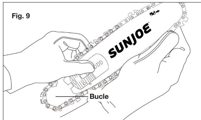
7. Sostenga la cadena en su lugar sobre la barra y coloque el bucle alrededor del piñón. Coloque la barra nivelada contra la superficie de montaje de manera que los pernos de barra estén en la ranura larga de la barra, y la clavija de ajuste esté en el orificio de clavija de tensión de cadena (Fig. 10).
