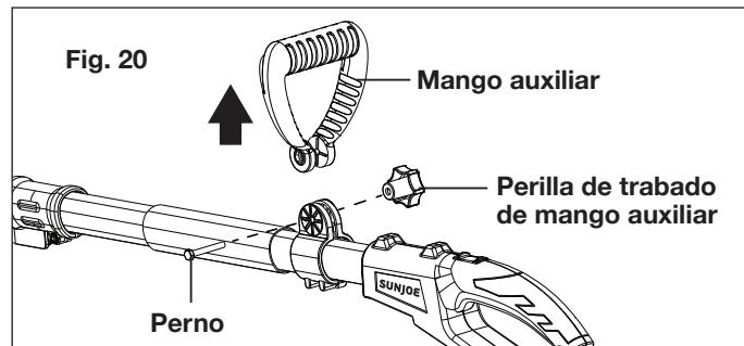
3. Reensamble la perilla de trabado de mango auxiliar y el perno (Fig. 21).
