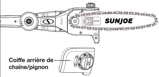
3. Retirez le guide-chaîne et la chaîne de la surface de fixation (Fig. 6).
