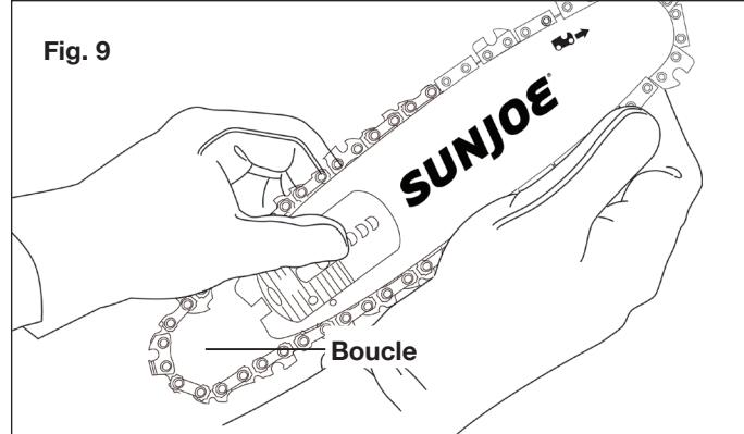
7. Maintenez la chaîne en position sur le guide-chaîne et enroulez la boucle autour du pignon. Placez le guide-chaîne de manière à ce qu'il repose bien contre la surface de fixation, que les goujons du guide-chaîne soient dans la longue fente du guide-chaîne et que la goupille de réglage soit dans le trou de la goupille de tension de chaîne (Fig. 10).
