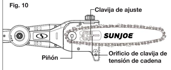
8. Vuelva a colocar la cubierta de extremo de cadena/piñón sobre el cabezal de la motosierra. Apriete la perilla de cubierta de extremo, pero deje la barra con libre movimiento para el ajuste de tensión. Reinstale el perno hexagonal enroscándolo en sentido horario con la llave hexagonal.
