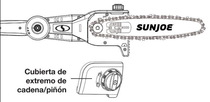
3. Retire la barra-guía y cadena de la superficie de montaje (Fig. 6).
