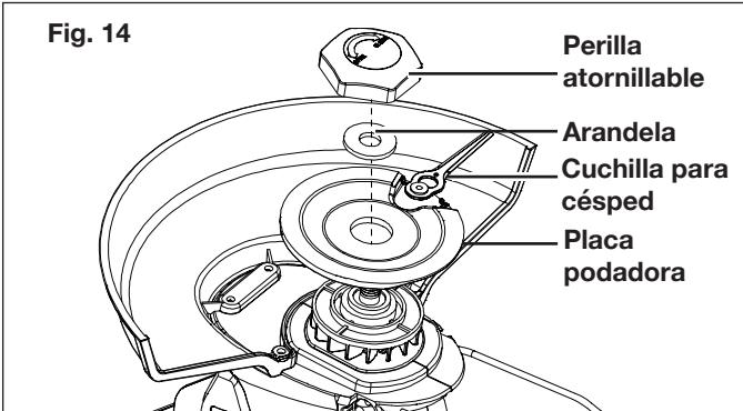
4. Instale la nueva SharperBlade™ en la podadora + bordeadora inalámbrica de césped con la arandela colocada en el medio (Fig. 14). Asegure todo el ensamblado con la perilla atornillable enroscándola en sentido horario.
