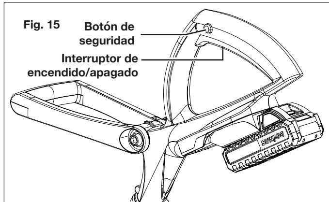
2. Para apagar la unidad, suelte el interruptor de encendido/apagado (Fig. 15). Retire la batería.
