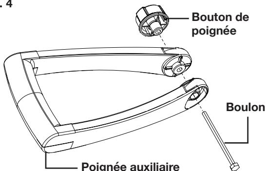
2. Positionnez la poignée auxiliaire et alignez les trous. Attachez-la à l'aide du boulon et du bouton de poignée. Serrez le bouton de poignée (Fig. 5).
