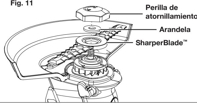
3. Instale la nueva SharperBlade™ a la podadora + bordeadora inalámbrica, con la arandela colocada en el medio (Fig. 11). Fije todo el ensamblado con la perilla de atornillamiento. Gírela en sentido horario para asegurarla.
