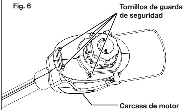
2. Coloque el protector sobre la carcasa de motor tal como se muestra. Alinee los orificios. Fíjelo con los cuatro tornillos de protector originales. Apriete para asegurar (Fig. 7).
