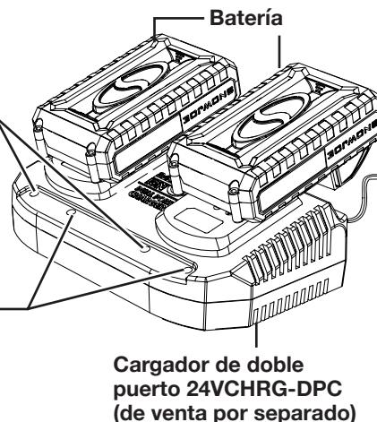
3. Las luces LED indicadoras de la batería se iluminarán una a una durante el proceso de carga. Desconecte el cargador inmediatamente cuando las tres luces LED estén iluminadas.
