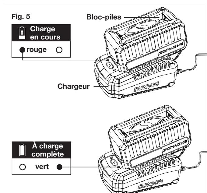
4. Lorsque le voyant du chargeur passe au vert, la batterie est à charge complète (Fig. 5).
