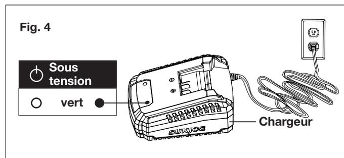
3. Insérez le bloc-piles dans le chargeur en le faisant glisser jusqu'à ce qu'il se mette en place en se verrouillant. Lorsque vous insérez la batterie dans le chargeur, le voyant vert en haut à droite s'éteint et le voyant rouge en haut à gauche s'allume pour indiquer que la batterie se charge (Fig. 5).
