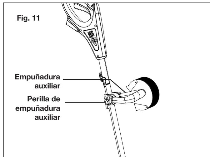
3. Fije la empuñadura apretando la perilla de empuñadura auxiliar. Inserte la batería y reinicie sus labores.
