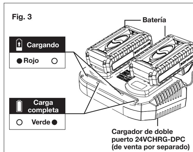
3. Las luces LED indicadoras de la batería se iluminarán una a una durante el proceso de carga. Desconecte el cargador inmediatamente cuando las tres luces LED estén iluminadas.
