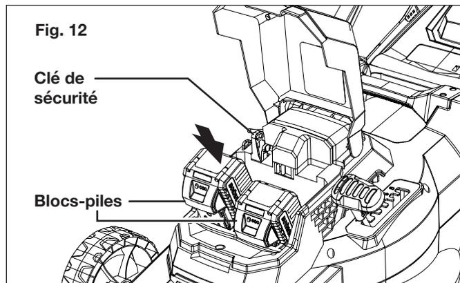
2. Pour démarrer la machine, appuyez sur le bouton-poussoir de sécurité en le maintenant enfoncé, tout en pressant l'un des boutons marche/arrêt. Une fois que la machine a démarré, relâchez le bouton-poussoir de sécurité et commencez à tondre (Fig. 13).
