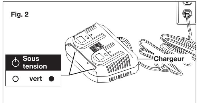
3. Insérez les blocs-piles dans le chargeur en les faisant glisser jusqu'à ce qu'ils se mettent en place en se verrouillant. Lorsque vous insérez les batteries dans le chargeur, les deux témoins verts s'éteignent et les témoins rouges s'allument pour indiquer que la charge des batteries est en cours (Fig. 3).
