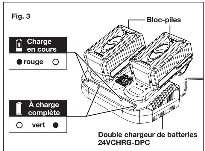
4. Lorsque les témoins du chargeur passent au vert, les batteries sont à charge complète (Fig. 3).
