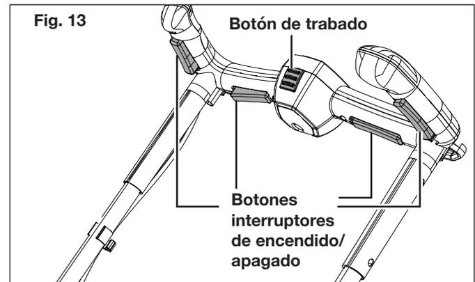
**NOTA:** para lograr la mayor comodidad durante la operación, la podadora viene con dos juegos de botones interruptores de encendido/apagado (un total de cuatro), y cualquiera de ellos puede activar la podadora. Elija el botón en base a su posición deseada para operar la podadora (Fig. 14).
