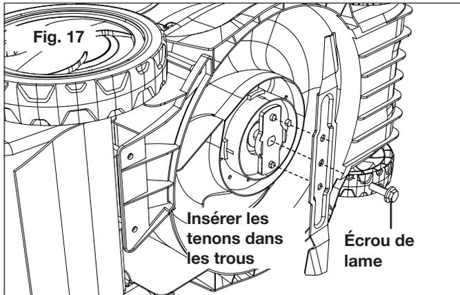
5. Posez la nouvelle lame dans la même position en insérant les deux petits tenons sur le moteur dans les trous pratiqués dans la lame, puis attachez la lame à l'aide de l'écrou d'origine.
