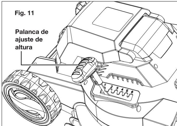
3. Inserte la palanca en la ranura deseada.
