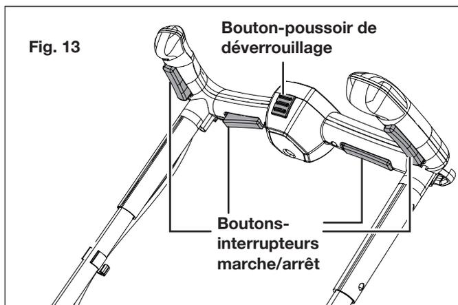
**REMARQUE :** pour l'utiliser de la façon la plus confortable possible, la tondeuse à gazon est dotée de deux jeux de boutons marche/arrêt (quatre au total), l'un ou l'autre de ces boutons pouvant à lui seul mettre en marche la tondeuse. Choisissez le bouton le mieux adapté à la position recherchée pour utiliser la tondeuse (Fig. 14).
