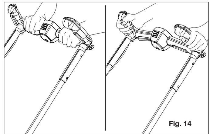
3. Para detener la podadora, suelte los botones interruptores de encendido/apagado.
