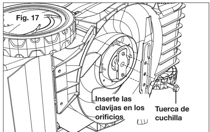
5. Coloque la nueva cuchilla en la misma posición insertando las dos clavijas pequeñas en el motor dentro de los orificios de la cuchilla, y asegúrela con la tuerca de cuchilla original.
