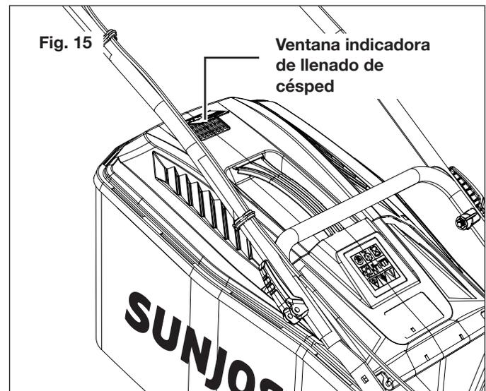
**NOTA:** para asegurarse de que el indicador de nivel de llenado funcione adecuadamente, mantenga los orificios debajo de la compuerta limpios y permeables.
