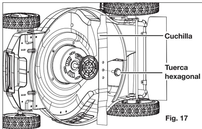
5. Coloque la nueva cuchilla en la misma posición, y asegúrela con la tuerca hexagonal original (Fig. 18).
