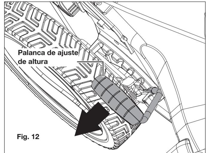
3. Inserte la palanca en la ranura deseada.
