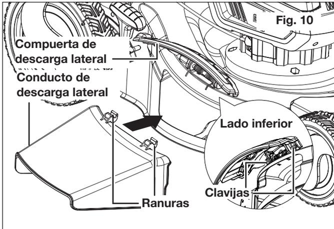
3. Suelte la compuerta de descarga lateral.
