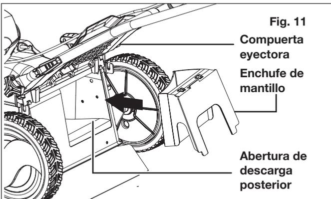
3. Suelte la compuerta eyectora.
