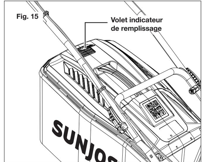
**REMARQUE :** pour s'assurer que l'indicateur de niveau de remplissage fonctionne normalement, maintenez les orifices sous le volet propres et perméables.
