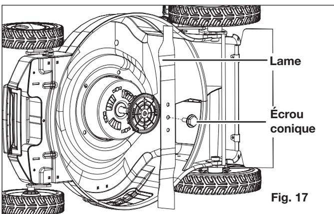
5. Montez la nouvelle lame dans la même position et attachez-la à l'aide de l'écrou conique (Fig. 18).
