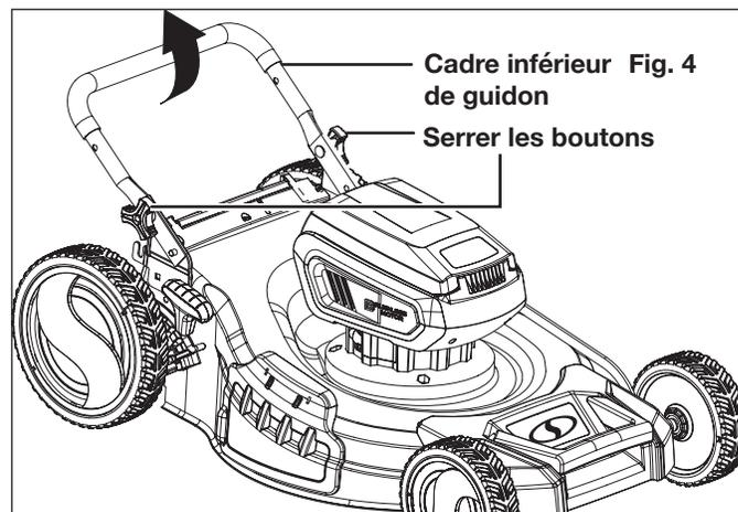
2. Assemblez le cadre supérieur de guidon sur le cadre inférieur de guidon. Insérez les leviers de serrage dans les rondelles et les trous alignés sur les cadres de guidon et attachez les leviers aux cadres de guidon (Fig. 5).
