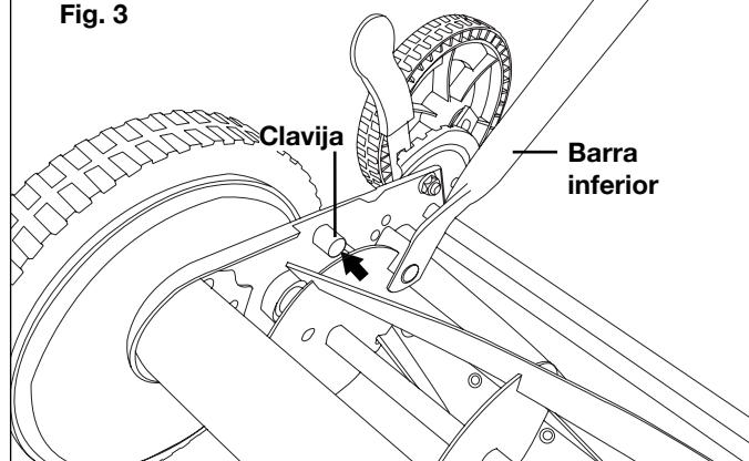
4. Jale ambas barras de manillar inferiores por sobre las clavijas del cuerpo de la podadora. Presione hacia dentro sobre las barras de manillar para garantizar un ajuste seguro sobre las clavijas.
