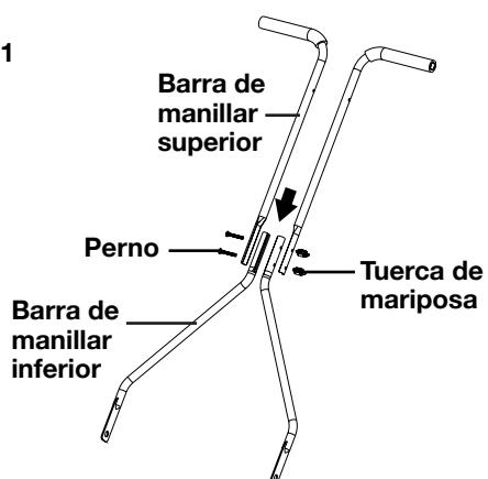
2. Conecte las dos barras de manillar superiores una a otra usando un perno y una tuerca de mariposa suministrados. Apriete la tuerca de mariposa para garantizar un ajuste seguro (Fig. 2).
