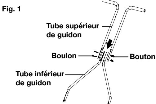
2. Attachez ensemble les deux tubes supérieurs de guidon à l'aide du bouton et du boulon fournis. Serrez le bouton pour bien attacher les deux tubes (Fig. 2).
