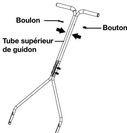
3. Après avoir assemblé le guidon, alignez les trous au niveau de l'extrémité inférieure de chaque tube de guidon avec les petits tenons qui ressortent des plaques latérales de la carcasse de la tondeuse (Fig. 3).
