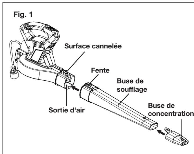
3. Pour retirer la buse de soufflage, faites glisser l'interrupteur marche-arrêt sur la position « (0) » (Arrêt) et débranchez l'outil de la source d'alimentation électrique (Fig. 2).
