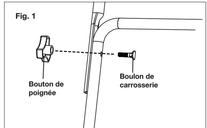
2. Attachez la poignée supérieure au cadre intermédiaire à l'aide des 2 boutons et des 2 boulons de carrosserie. Posez les boutons à l'extérieur de l'assemblage et serrez (Fig. 2).
