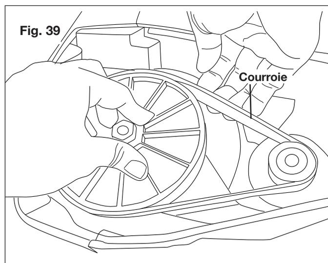
3. Placez d'abord la courroie sur la poulie d'entraînement et placez ensuite la courroie au niveau de l'extrémité inférieure de la poulie de tarière (Fig. 40).
