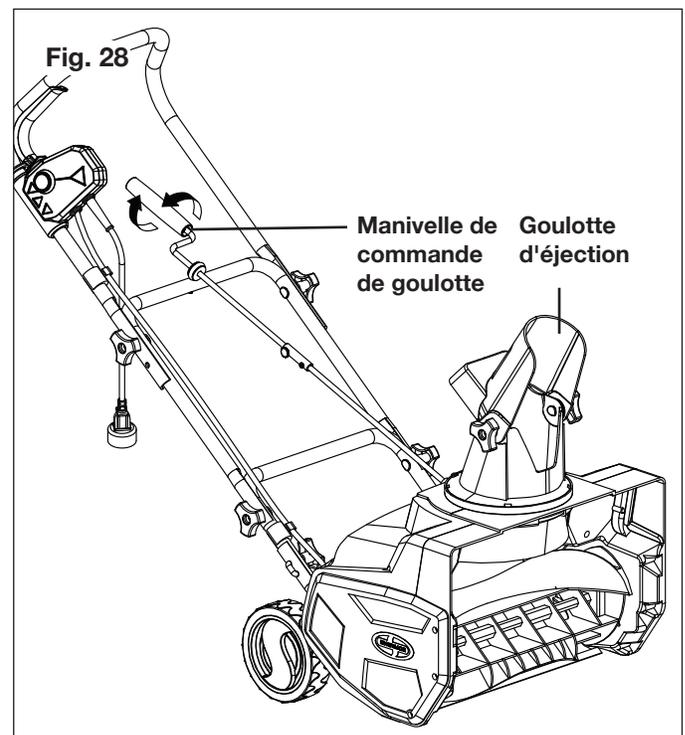
2. Le déflecteur de goulotte sur la partie supérieure de la goulotte d'éjection permet de contrôler la hauteur du jet de neige. Desserrez les boutons pour lever ou abaisser le déflecteur et obtenir la hauteur de jet de neige que vous souhaitez. Serrez les boutons pour attacher solidement le déflecteur (Fig. 29).
