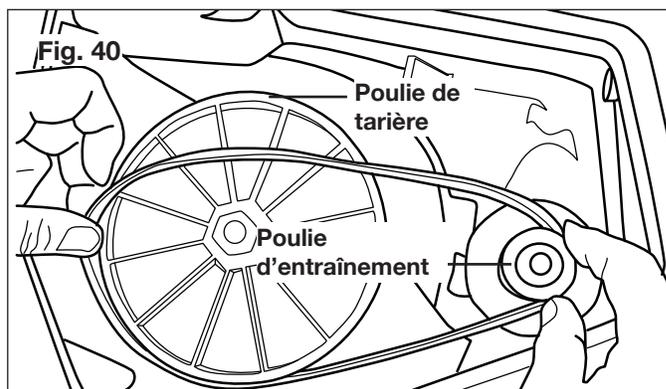
4. Utilisez la main droite pour appuyer sur la courroie, le côté nervure vers le bas. Tout en maintenant la courroie en bas à l'aide de la main droite, utilisez la main gauche pour faire tourner la tarière de telle sorte que la poulie tourne dans le sens des aiguilles d'une montre. La courroie sera progressivement poussée vers le bas sur la poulie. Quand la courroie repose sur la poulie, réglez-la pour que les nervures de la courroie viennent s'ajuster sur les gorges de la poulie (Fig. 41).
