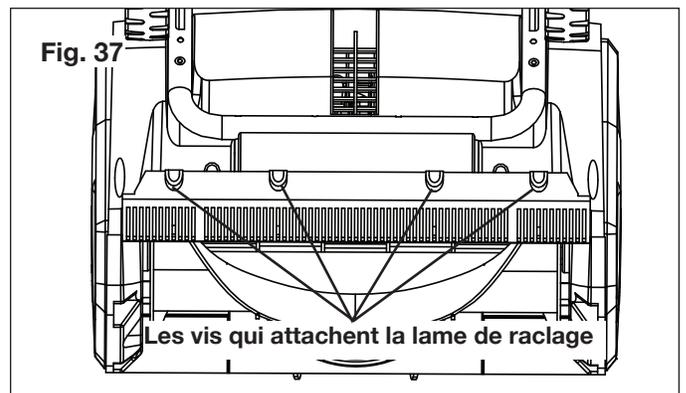
3. Posez la nouvelle lame de raclage et attachez-la solidement à la souffeuse à neige à l'aide des vis.
