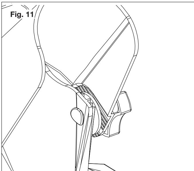
3. Gire la perilla de manivela en sentido horario para asegurarse de que el conducto de descarga y el deflector estén en sus posiciones correspondientes.
