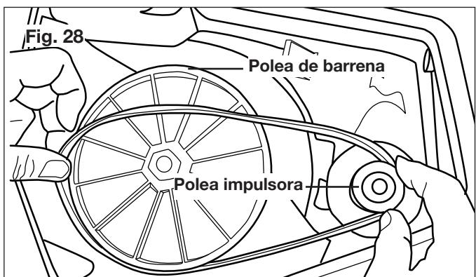
4. Use su mano derecha para presionar la correa con el lado con pliegues hacia abajo. Mientras sujetla la correa hacia abajo con su mano derecha, use su mano izquierda para girar el rotor hacia adelante de manera que la polea de rotor gire en dirección horaria. La correa será gradualmente empujada hacia abajo, hacia la polea. Cuando la correa está asentada en la polea, ajústela de manera que los pliegues de la correa encajen en las ranuras de la polea (Fig. 29).
