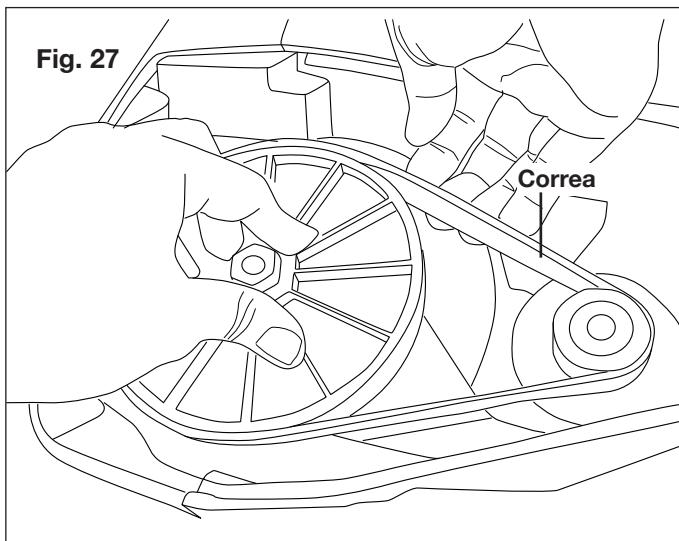
3. Coloque la correa en la polea impulsora primero y luego coloque la correa en el extremo inferior de la polea del rotor (Fig. 28).
