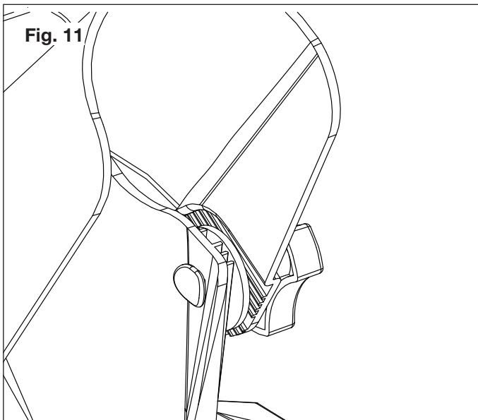
3. Tournez le bouton de manivelle dans le sens des aiguilles d'une montre pour vous assurer que la goulotte d'éjection et le déflecteur soient en position.
