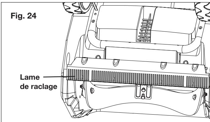
2. Retirez les vis qui attachent la lame de raclage à la souffleuse à neige (Fig. 25).
