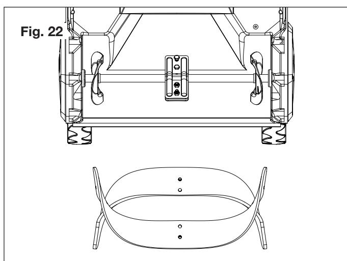
2. Instale la primera placa de goma de repuesto e inserte el perno apropiado en cada orificio correspondiente a cada parte de la placa de goma. Asegúrese de que las contratuerzas estén firmemente aseguradas a los pernos.
