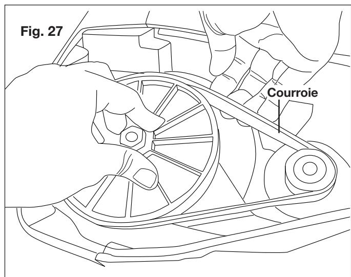
3. Placez d'abord la courroie sur la poulie d' entraînement et placez ensuite la courroie au niveau de l' extrémité inférieure de la poulie de tarière (Fig. 28).
