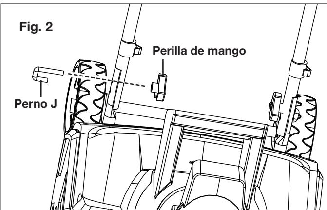
3. Asegure el ensamblado de mango intermedio al mango inferior usando las dos perillas y dos pernos J. Instale las perillas en la parte interior de la unidad, y apriételas (Fig. 3).
