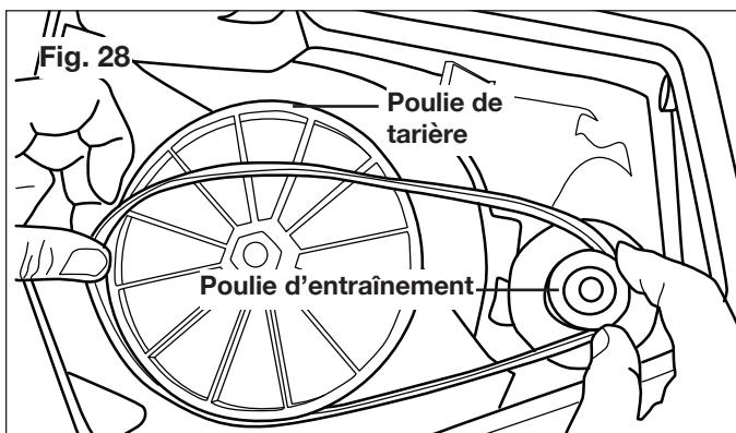
4. Utilisez la main droite pour appuyer sur la courroie, le côté nervure vers le bas. Tout en maintenant la courroie en bas à l'aide de la main droite, utilisez la main gauche pour faire tourner la tarière de telle sorte que la poulie tourne dans le sens des aiguilles d'une montre. La courroie sera progressivement poussée vers le bas sur la poulie. Quand la courroie repose sur la poulie, réglez-la pour que les nervures de la courroie viennent s'ajuster sur les gorges de la poulie (Fig. 29).
