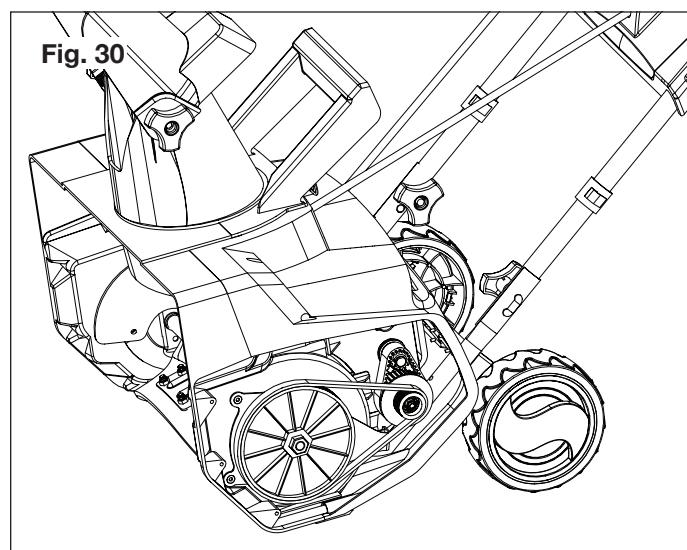
2. En empêchant la tarière de tourner et à l'aide d'une douille à six pans creux de 18 mm, tournez la poulie dans le sens des aiguilles d'une montre pour la retirer (Fig. 31).
