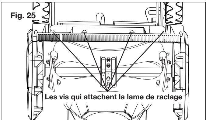
3. Posez la nouvelle lame de raclage et attachez-la solidement à la souffleuse à neige à l'aide des vis.
