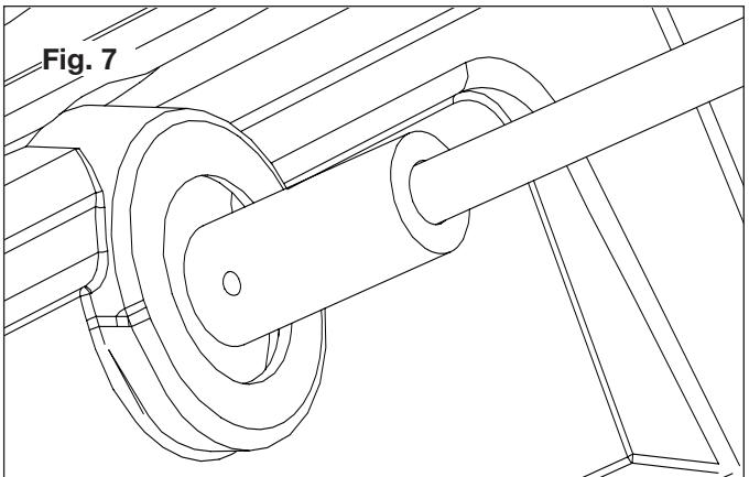
3. Une fois en place, attachez la tige de manivelle à l'aide de la goupille fendue (Fig. 8 et 9).
