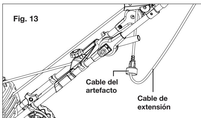
4. Note que el quitanieve tiene un conector macho polarizado, es decir que una pata en el conector es ligeramente más larga y ancha que la otra (Fig. 14). El extremo hembra del cable de extensión debe estar, del mismo modo, polarizado de tal manera que el cable de extensión encaje perfectamente en el conector del artefacto.
