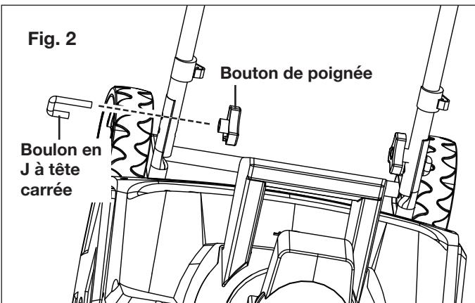
3. Attachez l'assemblage de poignée intermédiaire à la poignée inférieure en utilisant 2 boutons et 2 boulons en J. Posez les boutons à l'intérieur de l'assemblage et serrez (Fig. 3).
