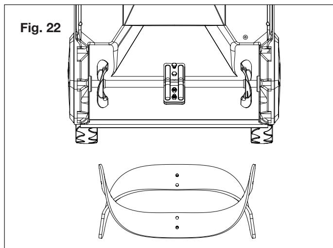
2. Posez le premier patin de rechange en caoutchouc et insérez le boulon approprié dans les trous correspondants de chaque partie du patin en caoutchouc. Assurez-vous que les écrous-freins soient solidement attachés aux boulons.
