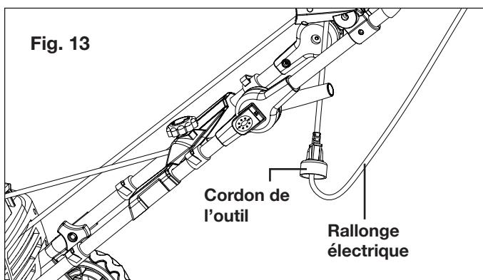
4. Notez que la souffleuse à neige est munie d'une prise mâle polarisée, une lame de la prise étant légèrement plus longue et plus large que l'autre (Fig. 14). L'extrémité femelle de la rallonge électrique doit être également polarisée pour que la rallonge électrique rentre parfaitement dans la prise de la machine.
