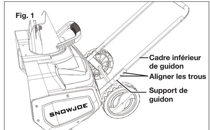
2. Attachez le cadre inférieur de guidon aux supports de guidon à l'aide des deux jeux de bouton et boulon en J, comme l'illustre la Fig. 2. Assurez-vous que les boutons sont serrés.
