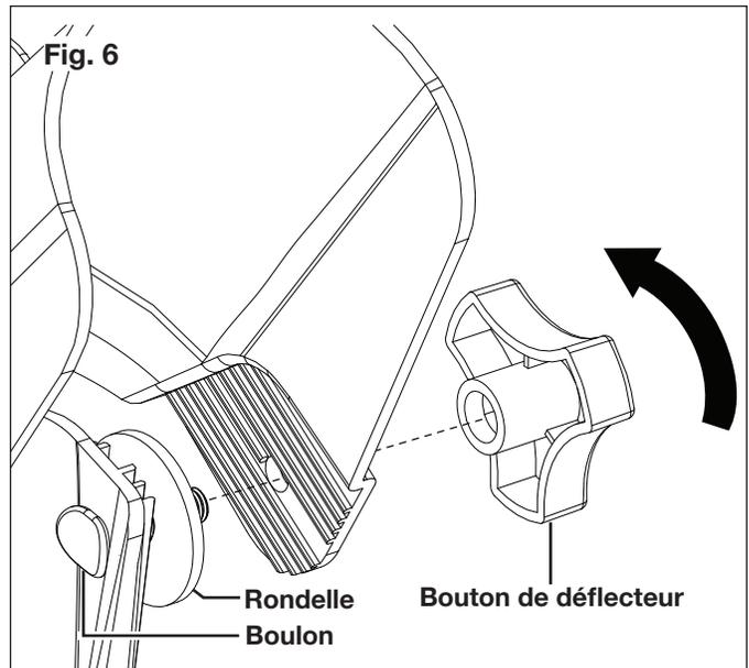
2. Serrez les boutons pour attacher solidement le déflecteur (Fig. 7).
