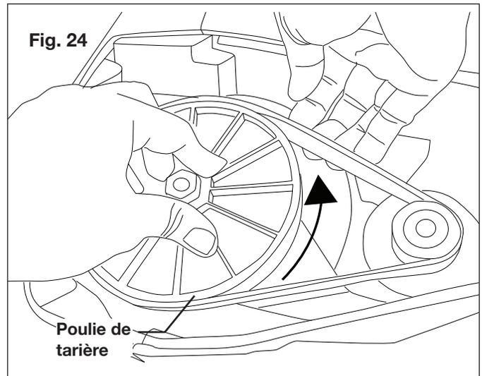
3. Placez d'abord la courroie sur la poulie d'entraînement, puis la courroie à l'extrémité inférieure de la poulie de tarière (Fig. 25).
