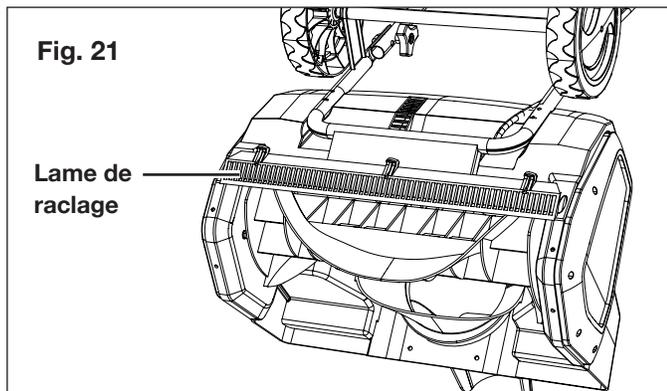
2. Retirez les trois vis qui attachent la lame de raclage à la souffleuse à neige (Fig. 22). Retirez la lame de raclage à changer.
