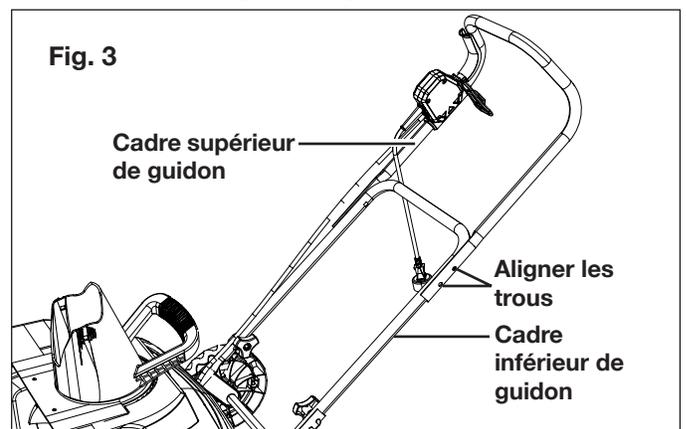
4. Attachez le cadre supérieur de guidon au cadre inférieur de guidon à l'aide des deux jeux de bouton et boulon de carrosserie, comme l'illustre la Fig. 4. Assurez-vous que les boutons sont serrés.
