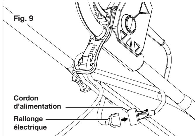
4. Notez que la souffleuse à neige est munie d'une prise mâle polarisée, une lame de la prise étant légèrement plus longue et plus large que l'autre (Fig. 10). L'extrémité femelle de la rallonge électrique doit être également polarisée pour que la rallonge électrique rentre parfaitement dans la prise de la machine.
