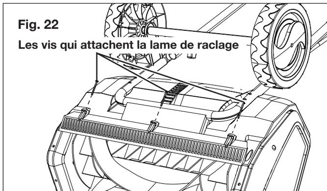
3. Posez la nouvelle lame de raclage et attachez-la solidement à la souffleuse à neige à l'aide des trois vis.
