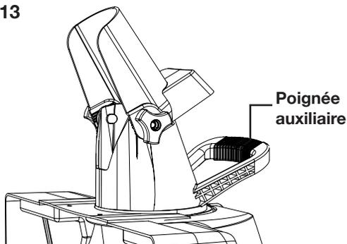
2. Le déflecteur de goulotte sur la partie supérieure de la goulotte d'éjection permet de contrôler la hauteur du jet de neige. Desserrez les boutons pour lever ou abaisser le déflecteur et obtenir la hauteur de jet de neige que vous souhaitez. Serrez les boutons pour attacher solidement le déflecteur (Fig. 14).
