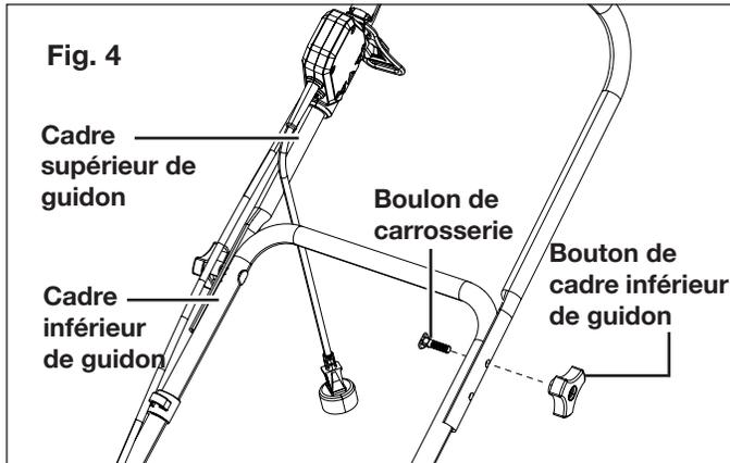
5. Attachez le câble dans les serre-câbles montés sur l'ensemble guidon inférieur.
