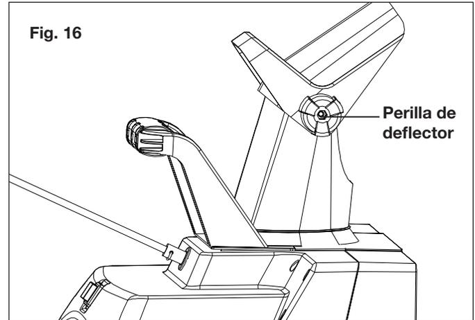
**⚠ ¡ADVERTENCIA!** Asegúrese de que el deflector del conducto se enganche y trabé completamente sobre el conducto de descarga. Una abertura entre el conducto de descarga y el deflector del conducto puede permitir que objetos extraños sean recogidos y lanzados por el quitanieve en dirección del operador, causando lesiones corporales severas.
