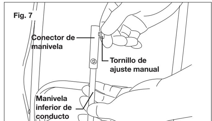
3. Introduzca la manivela superior del conducto dentro del conector de manivela (Fig. 8).
