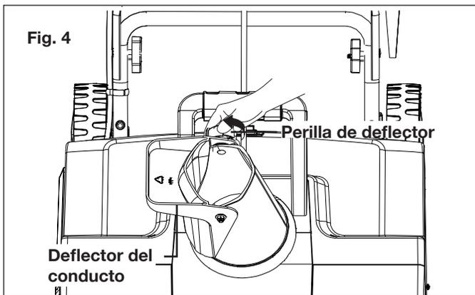
2. Asegure el deflector del conducto trabando la perilla de deflector (Fig. 5).
