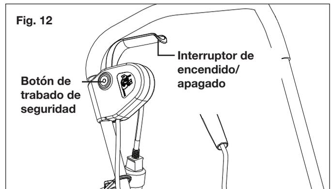
3. Para apagar la máquina, suelte la palanca de encendido.
