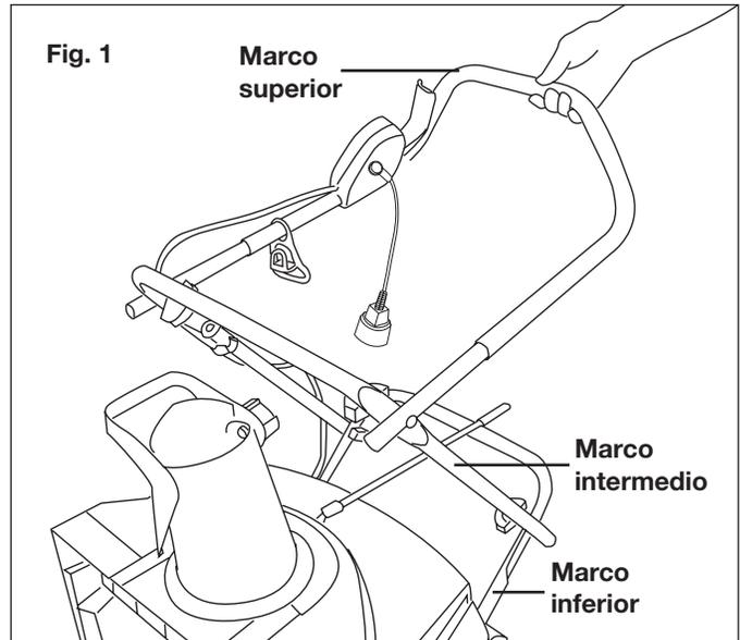
2. Asegure la conexión del marco intermedio con el marco inferior ajustando el primer juego de tuercas de mariposa y pernos en ambos lados (Fig. 2).
