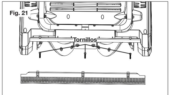
3. Instale la nueva barra raspadora y ajústela de forma segura al quitanieve con los tres tornillos (Fig. 21).
