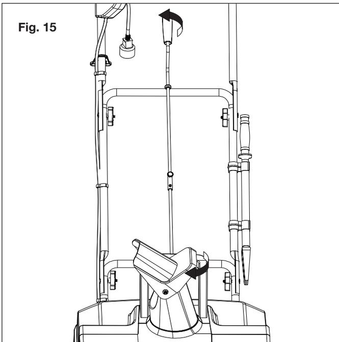
2. El deflector del conducto en la parte superior del conducto de descarga controla la altura del flujo de nieve. Afloje la perilla para levantar o bajar el deflector a la altura deseada de nieve que usted desee lanzar. Apriete la perilla para asegurar el deflector (Fig. 16).
