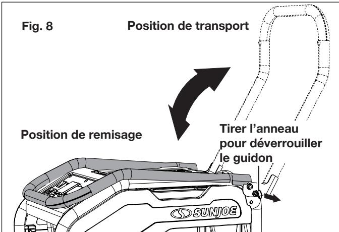
**! MISE EN GARDE!** Ne pas essayer de lever le générateur par l'ensemble guidon. S'il s'avère nécessaire de lever le générateur, toujours le saisir par son ossature. Pour éviter des maux de reins, utiliser des techniques de levage appropriées.
