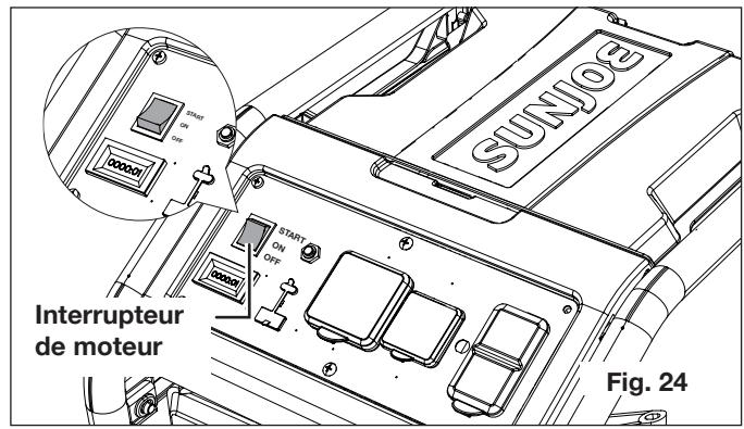
**REMARQUE :** avant de pouvoir procéder au démarrage électrique du générateur, il faudra peut-être recharger la batterie. Dans ce cas, démarrer le moteur manuellement comme décrit ci-dessous.
