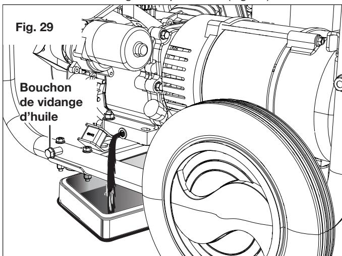
**AVERTISSEMENT!** Vidanger le lubrifiant pendant que le moteur est encore tiède, mais pas chaud. Un lubrifiant tiède se vidangera rapidement et plus complètement.
