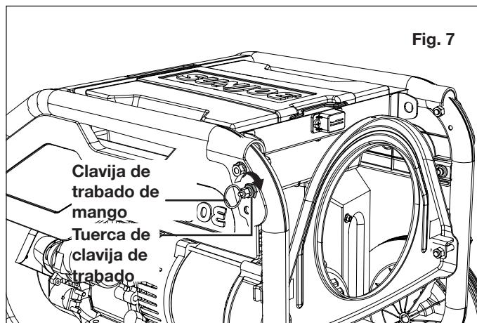
3. Para extender el mango, jale el anillo de la clavija de trabado para desatrabar el mango, y levante el mango a la posición de transporte. Suelte el anillo para tratar el mango en su lugar. Para soltar el mango, jale el anillo de
