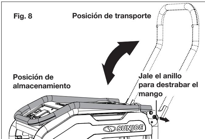
**⚠ ¡PRECAUCIÓN!** No intente levantar la unidad por el mango. Si es necesario levantar el generador, siempre sujetelo por su estructura. Use técnicas adecuadas de levantamiento para evitar lesiones a la espalda.
