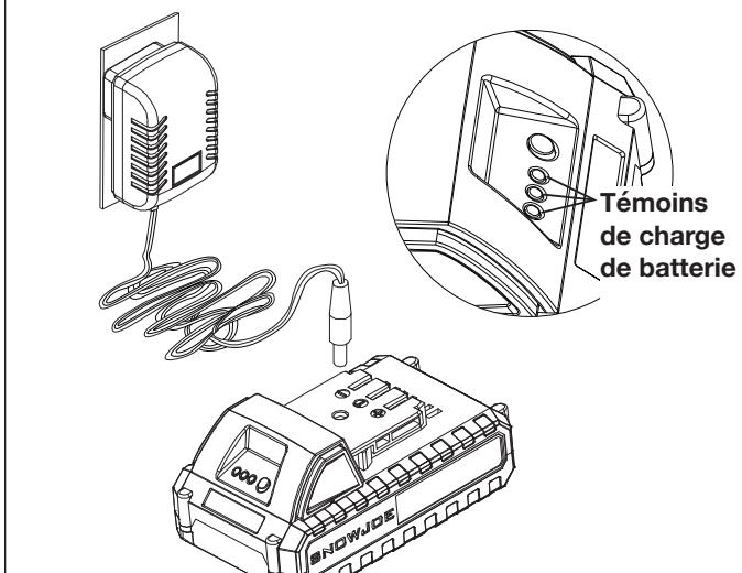
3. Il faut environ cinq heures pour charger la batterie. Les témoins de charge de batterie scintilleront et s'allumeront un par un pendant le processus de charge. Débranchez immédiatement le chargeur lorsque les témoins de charge sont tous les trois allumés.
