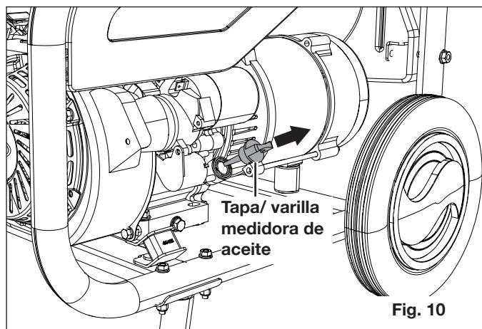
2. Limpie la varilla y vuélvala a insertar en el orificio. No la enrosque. Retire la varilla nuevamente y compruebe el nivel de lubricante. El nivel de lubricante debe estar entre la marca L ("bajo") y la marca H ("alto") en la varilla (Fig. 11).
