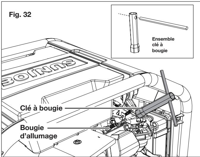
5. Inspectez la bougie d'allumage pour vérifier qu'elle n'est pas endommagée et nettoyez-la à l'aide d'une brosse métallique avant de la remplacer. Si l'isolant est fissuré ou écaillé, la bougie d'allumage doit être remplacée.
