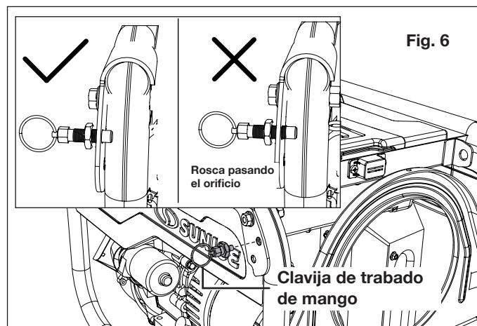
2. Sujetando la clavija de trabado, use una llave para girar en sentido horario la tuerca en la clavija de trabado para asegurarla (Fig. 7).
