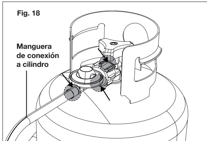
3. Abra la válvula del cilindro. Inspeccione las conexiones y esté atento a la presencia de burbujas. Si no hay burbujas, la conexión es segura. Si aparecen burbujas, hay una fuga. Afloje y vuelva a ajustar esta conexión. Si aún hay una fuga, cierre el cilindro y comuníquese con la central de servicio al cliente Snow Joe® + Sun Joe® llamando al 1-866-SNOWJOE (1-866-766-9563).
