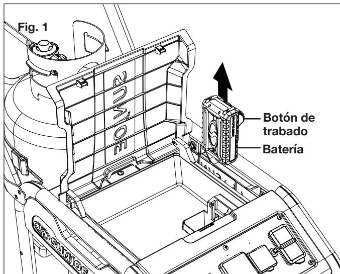
2. Compruebe que el voltaje de la red sea el mismo que el indicado en la placa de especificaciones del cargador de baterías. Luego, enchufe el adaptador del cargador en un tomacorriente CA apropiado. Conecte el conector del
