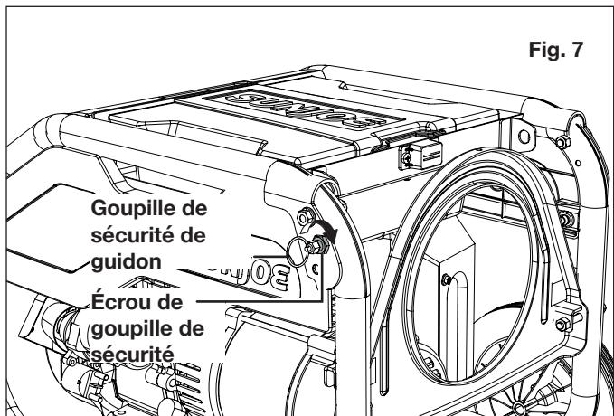
3. Pour déployer le guidon, tirez l'anneau de la goupille de sécurité pour déverrouiller le guidon et relevez le guidon
