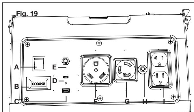
**A. Interrupteur du moteur :** utilisez l'interrupteur du moteur pour démarrer le générateur.
