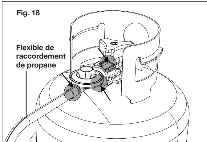
3. Ouvrez la bonbonne. Inspectez les branchements et vérifiez si des bulles se forment. Si aucune bulle ne se forme, le branchement est étanche. S'il y a des bulles, il y a une fuite. Desserrez et resserrez ce branchement. Si la fuite persiste, fermez la bonbonne et communiquez avec le service à la clientèle Snow Joe® + Sun Joe® au 1-866-SNOWJOE (1-866-766-9563).
