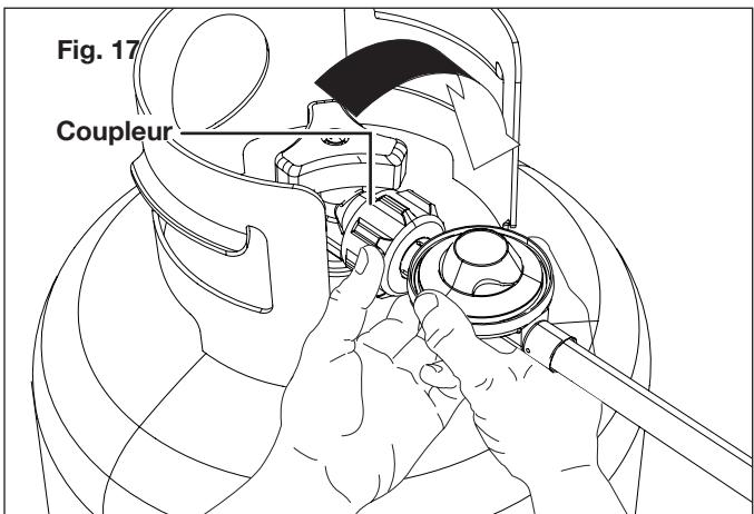
6. Inspectez le branchement de la soupape et le flexible de raccordement de propane. Vérifiez qu'ils ne sont ni endommagés ni couverts de débris. Retirez tous les débris. Inspectez le flexible pour vérifier qu'il n'est pas endommagé. N'essayez jamais d'utiliser un raccord ou un flexible endommagé ou obstrué. Pour leur réparation, consultez votre fournisseur de propane local.
