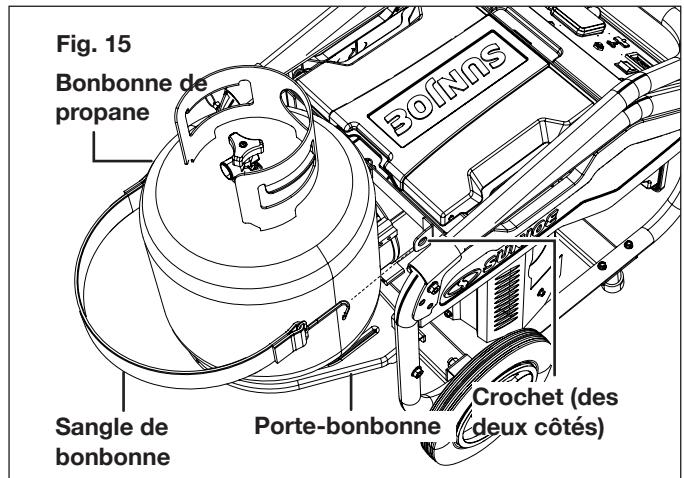
3. Assurez-vous que la soupape de la bonbonne est tournée dans le sens horaire en position fermée. Tenez fermement le flexible de raccordement de propane et insérez le raccord double mâle dans la soupape de la bonbonne (Fig. 16).
