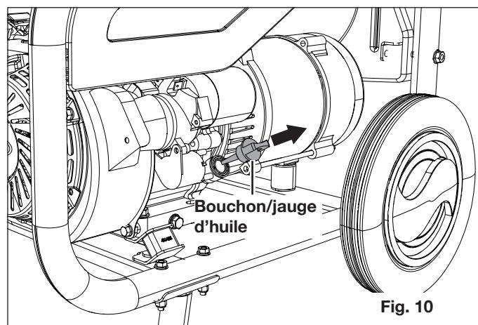
2. Essuyez la jauge et replacez-la dans l'orifice; ne la revissez pas. Retirez à nouveau la jauge et vérifiez le niveau de lubrifiant. Le niveau de lubrifiant doit se situer entre la marque L et la marque H sur la jauge (Fig. 11).
