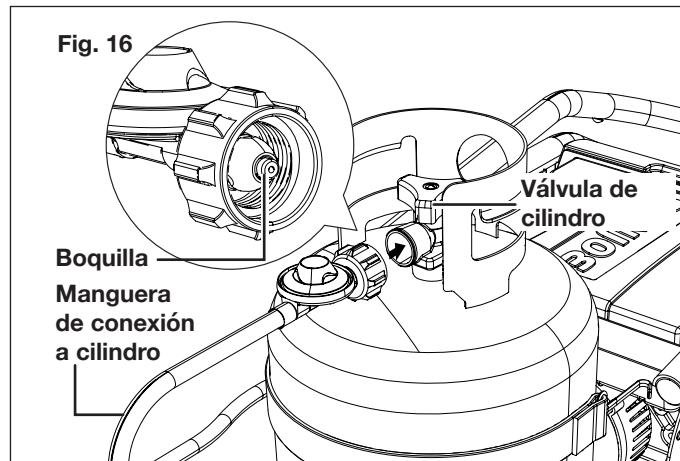
5. Sujetando el acoplador y manguera tal como se muestra, gire el acoplador en sentido horario y apriételo con la mano, asegurándose de no forzar la rosca de conexión. No use herramientas (Fig. 17).
