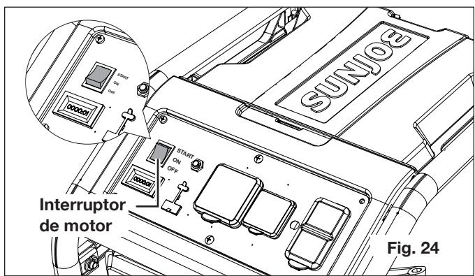
5. Presione el interruptor del motor a la posición **ON** (“encendido”) (Fig. 22).
