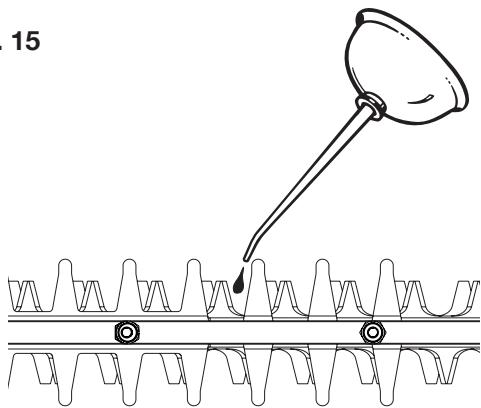
Si estará usando la bordeadora de arbustos de altura por un periodo prolongado, se recomienda detener el trabajo de forma intermitente para re-aceitar las cuchillas.
