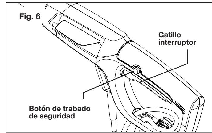
2. Para apagar la herramienta, suelte el gatillo interruptor (Fig. 6).
