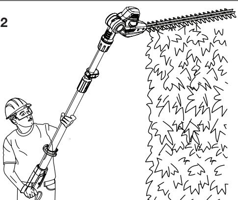
2. Para usar la bordeadora de arbustos de altura en la poda de partes inferiores y laterales de arbustos y maleza, sujetela bordeadora de arbustos de altura en la posición mostrada a continuación (Fig. 13).
