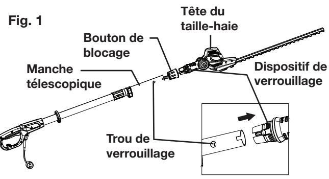
3. Faites glisser le bouton de blocage sur le dispositif de verrouillage et faites tourner le bouton de blocage dans le sens des aiguilles d'une montre pour qu'il ne bouge plus (Fig. 2).
