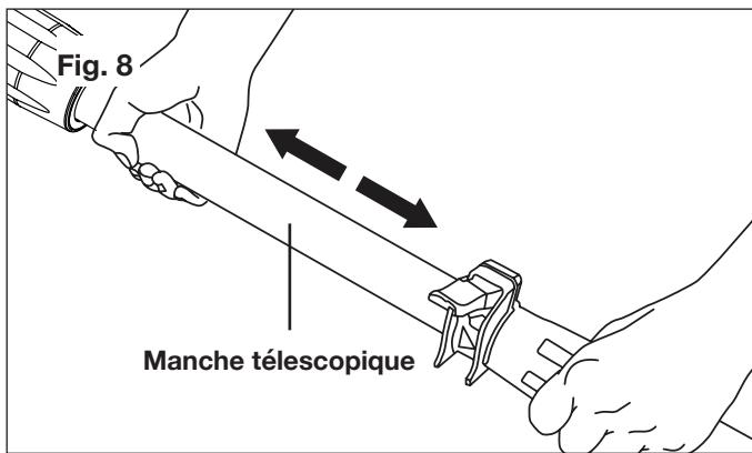
4. Verrouillez le manche à la longueur voulue en fermant la came de serrage (Fig. 9) et assurez-vous que le manche est bien attaché. Si le manche se rallonge ou se raccourcit quand la came de serrage est fermée, l'écrou doit être resserré.
