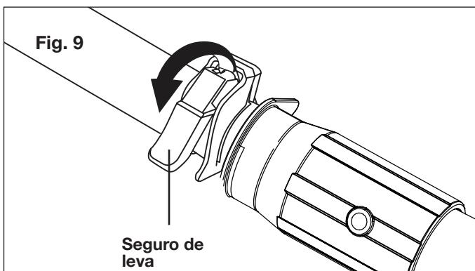
! **¡ADVERTENCIA!** Extienda el tubo telescópico solo hasta la longitud requerida para alcanzar los arbustos a ser podados. Ajuste la posición de su mano en el tubo telescópico de la bordeadora de arbustos de altura para mantener un equilibrio apropiado.
