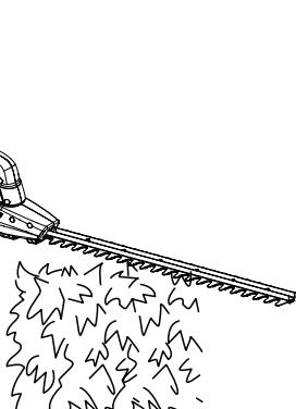
3. Para usar la bordeadora de arbustos de altura en la poda de follaje de baja altura o en el suelo, sujetela bordeadora de arbustos de altura en la posición mostrada a continuación (Fig. 14).
