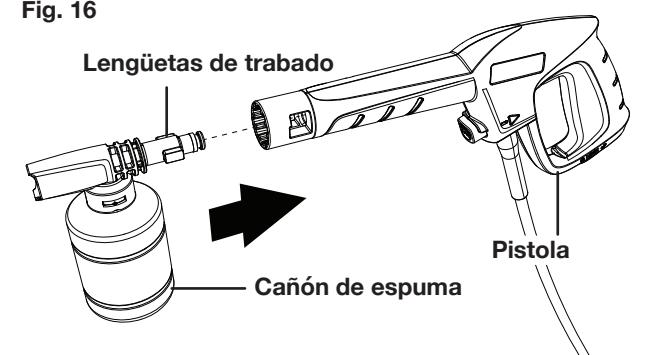
5. Encienda la hidrolavadora. Apriete el gatillo para operar la unidad. El líquido detergente se mezclará automáticamente con el agua y será descargado a través de la boquilla.
