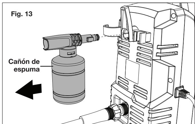
2. Saque la boquilla de rociado girándola en sentido antihorario. Llene con detergente la botella del cañón de espuma, o mezcle el detergente según lo recomendado en las instrucciones del fabricante, antes de volver a colocar la boquilla de rociado en la botella (Fig. 14).
