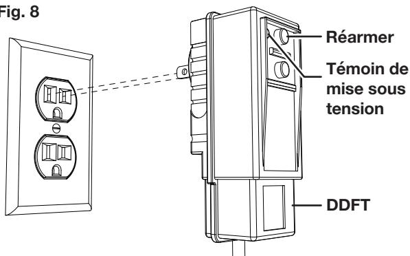
**REMARQUE :** il se peut que le DDFT nécessite d'être d'abord branché dans la prise électrique. Appuyez sur le bouton « Reset » (Réarmer) jusqu'à ce que le voyant de mise sous tension sur le DDFT s'allume lorsque la machine est branchée.
