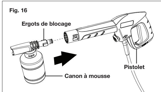
1. Mettez en marche le nettoyeur haute pression. Pressez la gâchette pour utiliser la machine. Le détergent liquide se mélangera automatiquement à l'eau et sera pulvérisé en passant par la buse.
