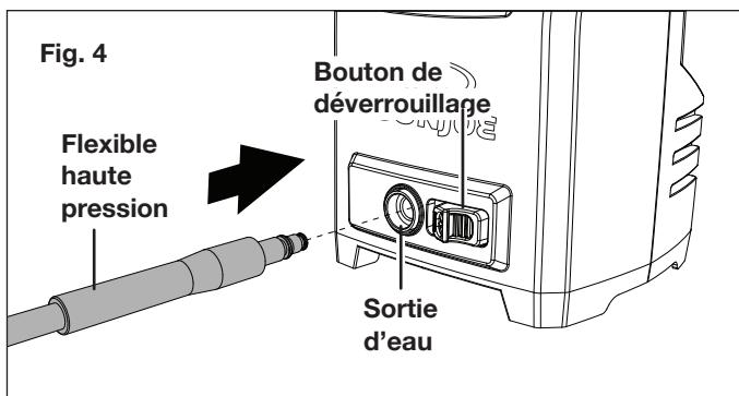
**AVERTISSEMENT!** Maintenir le flexible à l'écart des objets tranchants. Un tuyau qui éclate peut blesser. Examiner régulièrement le flexible et le remplacer s'il est endommagé. Ne pas essayer de réparer un flexible endommagé.
