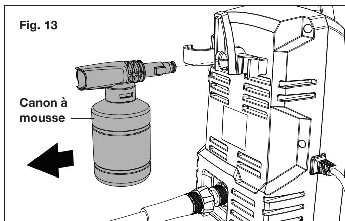
2. Tournez dans le sens antihoraire pour retirer la buse de pulvérisation. Avant de replacer la buse de pulvérisation
