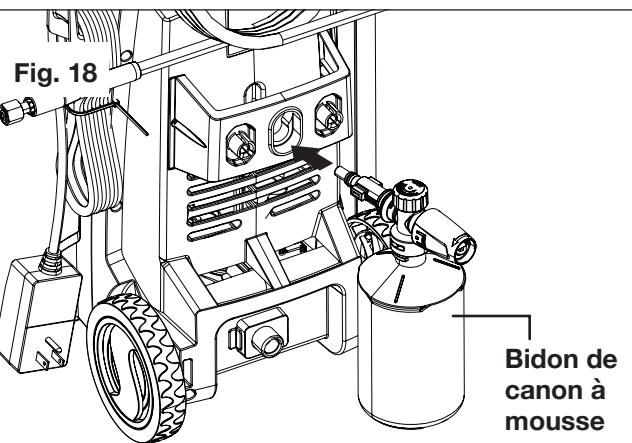
2. Retirez le bouchon. Remplissez le bidon d'un détergent après l'avoir mélangé ou non selon les instructions recommandées pour le détergent (Fig. 19) et rebouchez le bidon. Remettez en place le bidon sur la machine.
