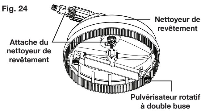
3. Une fois l'alignement réalisé, tournez fermement la bague de blocage sur le pulvérisateur rotatif à double buse pour le verrouiller une fois en place (Fig. 25).
