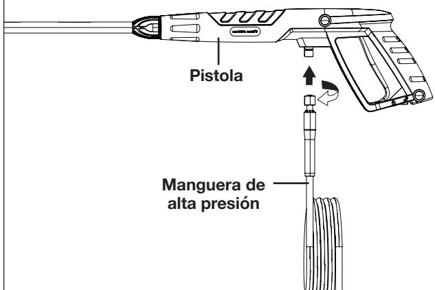
8. Conecte el otro extremo de la manguera de alta presión a la salida de agua en la hidrolavadora (Fig. 9). Primero empuje el extremo de la manguera de alta presión por completo sobre la salida de agua de alta presión, y luego enrósquelo en sentido horario. Apriete firmemente.
