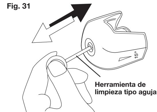
3. Retire la suciedad adicional retro-lavando con agua a través de la boquilla y la vara rociadora. Para hacer esto, coloque el extremo de la manguera de jardín (con agua fluyendo) en la punta de la boquilla, empujando el agua y los residuos por la abertura posterior de la boquilla y la vara rociadora.
