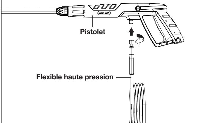
8. Branchez l'autre extrémité du flexible haute pression sur la sortie d'eau de la machine (Fig. 9). Poussez d'abord complètement l'embout du flexible haute pression sur la sortie d'eau à haute pression, puis vissez-le dans le sens des aiguilles d'une montre. Serrez bien.
