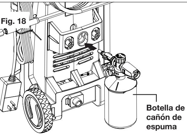
2. Retire la tapa. Llene la botella o mezcle según lo recomendado por las instrucciones del fabricante de detergente (Fig. 19), y asegure la tapa de vuelta en su lugar. Coloque la botella de vuelta en la unidad.
