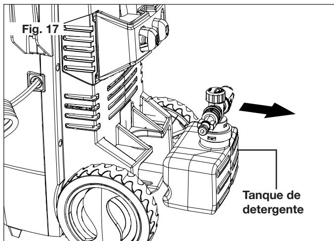
2. Retire la tapa. Llene el tanque o mezcle según lo recomendado por las instrucciones del detergente (Fig. 18), y vuélvala a colocar en la unidad. Vuelva a colocar de forma segura la tapa en su lugar.
