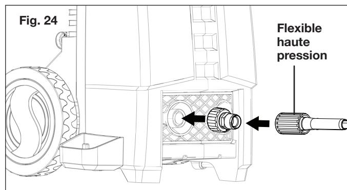
4. Branchez l'extrémité femelle du raccord en aluminium sur le pistolet. Branchez ensuite l'extrémité du flexible haute pression (filetage M22 14 mm) sur l'extrémité mâle du raccord en aluminium (Fig. 25).
