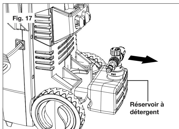
2. Retirez le bouchon. Remplissez le réservoir d'un détergent ou d'un mélange selon les instructions du fabricant du détergent (Fig. 18) et replacez le réservoir sur la machine. Remettez le bouchon en place.
