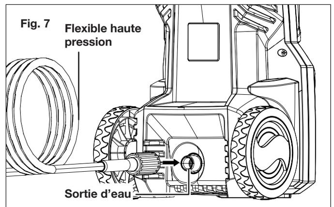
**⚠ AVERTISSEMENT!** Maintenir le flexible haute pression à l'écart des objets tranchants. Un tuyau souple qui éclate peut causer des blessures. Examiner régulièrement les tuyaux souples et les remplacer s'ils sont endommagés. Ne pas essayer de réparer un tuyau souple endommagé.
