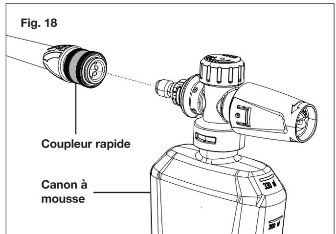
4. Mettez en marche le nettoyeur haute pression. Pressez la gâchette pour utiliser la machine. Le détergent liquide se mélangera automatiquement à l'eau et sera pulvérisé en passant par la buse.
