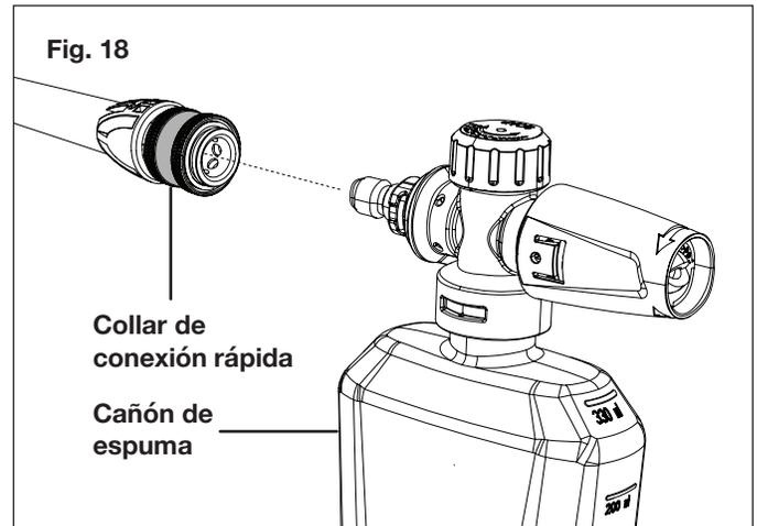
4. Encienda la hidrolavadora. Apriete el gatillo para operar la unidad. El líquido detergente se mezclará automáticamente con el agua y será descargado a través de la boquilla.
