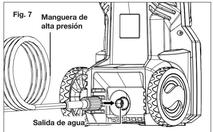
**⚠ ¡ADVERTENCIA!** Mantenga la manguera alejada de objetos afilados. Una manguera que reviente puede causar lesiones personales. Examine las mangueras regularmente y reemplácelas si están dañadas. No intente reparar una manguera dañada.
