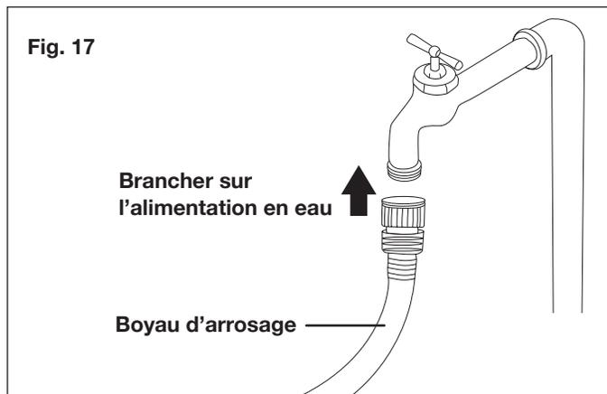
**⚠️ AVERTISSEMENT!** La température de l'eau à l'entrée du nettoyeur ne doit pas être supérieure à 40 °C. Sa pression ne doit pas être supérieure à 0,7 MPa.
