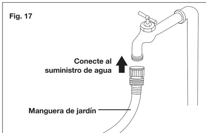
**⚠ ¡ADVERTENCIA!** La temperatura del agua entrante no debe exceder los 104°F (40°C). La presión del suministro de agua no debe exceder los 0.7 MPa.
