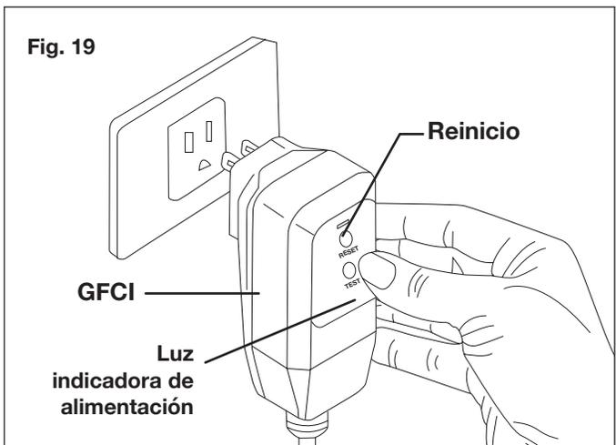
**NOTA:** es posible que el GFCI tenga que reiniciarse al enchufarlo por primera vez al tomacorriente. Presione el botón "Reset" ("reinicio") hasta que la luz indicadora de alimentación del GFCI se encienda.
