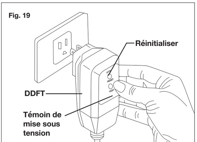
**REMARQUE :** il se peut que le DDFT nécessite d'être d'abord branché dans la prise électrique. Appuyez sur le bouton « Reset » (Réinitialisation) jusqu'à ce que le voyant de mise sous tension sur le DDFT s'allume.
