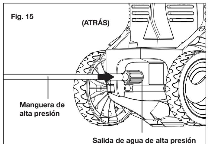
**⚠ ¡ADVERTENCIA!** Mantenga la manguera alejada de objetos afilados. Una manguera que revienta puede causar lesiones personales. Examine las mangueras regularmente y reemplácelas si están dañadas. No intente reparar una manguera dañada.
