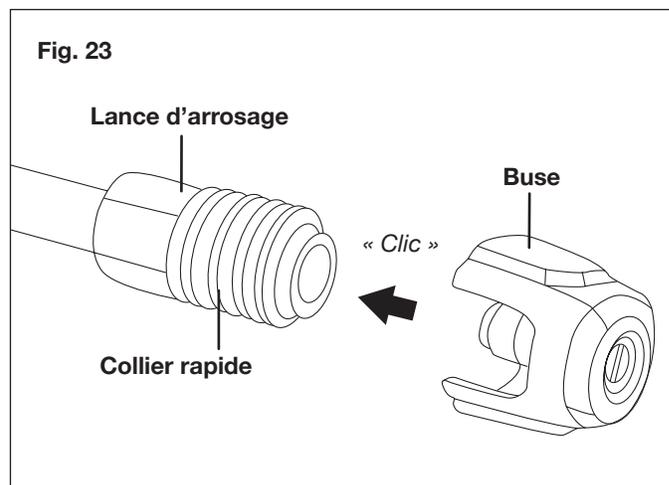
Pour débrancher la buse de la lance d'arrosage une fois que le nettoyage est achevé :
