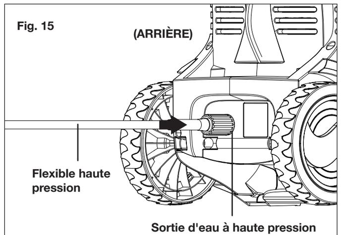
**⚠️ AVERTISSEMENT!** Maintenir le flexible haute pression à l'écart des objets tranchants. Un flexible haute pression qui éclate peut causer des blessures. Examiner régulièrement le flexible haute pression et le remplacer s'il est endommagé. Ne pas essayer de réparer un flexible haute pression endommagé.
