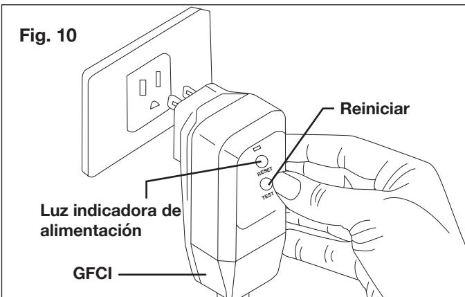
**NOTA:** es posible que el GFCI tenga que reiniciarse al enchufarlo por primera vez al tomacorriente. Presione el botón de reinicio hasta que la luz indicadora de alimentación del GFCI se prenda al ser enchufado.
