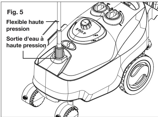
**AVERTISSEMENT!** Maintenir le flexible haute pression à l'écart des objets tranchants. Un flexible haute pression qui éclate peut être à l'origine de blessures. Examiner régulièrement le flexible haute pression et le remplacer s'il est endommagé. Ne pas essayer de réparer un flexible haute pression endommagé.
