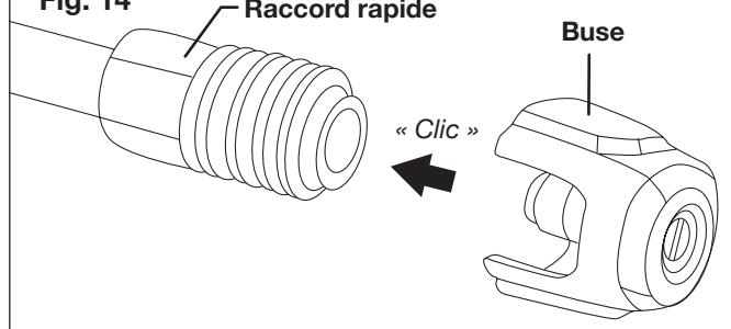
Pour débrancher la buse de la lance d'arrosage une fois que le nettoyage est achevé :
