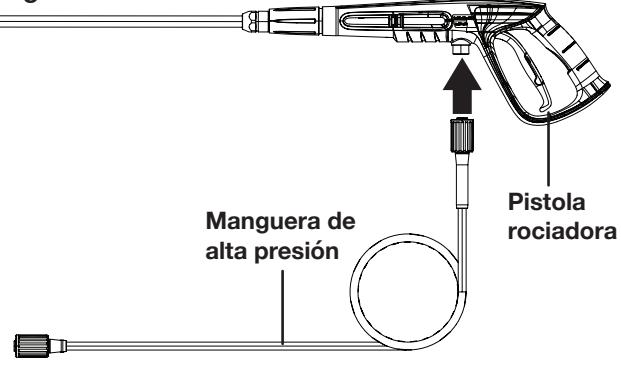
5. Conecte el otro extremo de la manguera de alta presión a la salida de agua en la hidrolavadora (Fig. 5).
