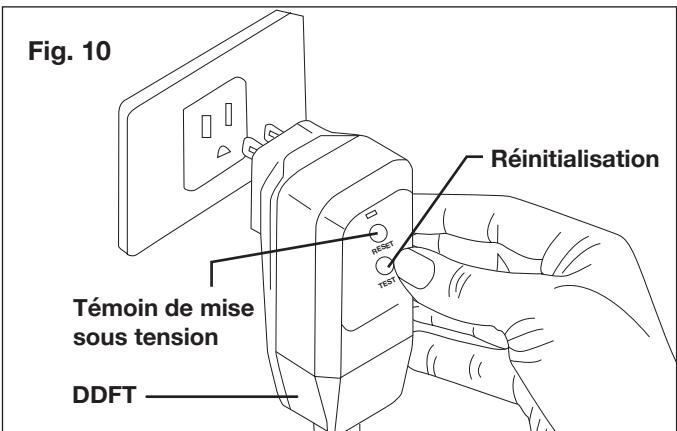
**REMARQUE :** il se peut que le DDFT nécessite d'être d'abord branché dans la prise électrique. Appuyez sur le bouton « Reset » (Réinitialisation) jusqu'à ce que le voyant de mise sous tension sur le disjoncteur de fuite de terre s'allume quand la machine est branchée.
