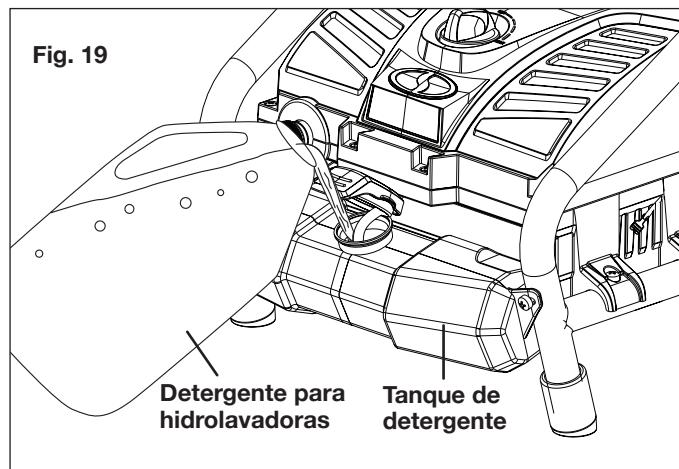
3. Encienda la hidrolavadora. Apriete el gatillo para operar la unidad. El líquido detergente se mezclará automáticamente con el agua y será descargado a través de la boquilla.
