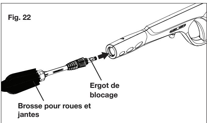
**3.** Une fois l'alignement réalisé, poussez la Brosse pour roues et jantes dans le pistolet et tournez-la dans le sens antihoraire afin qu'elle se mette en place et se verrouille.
