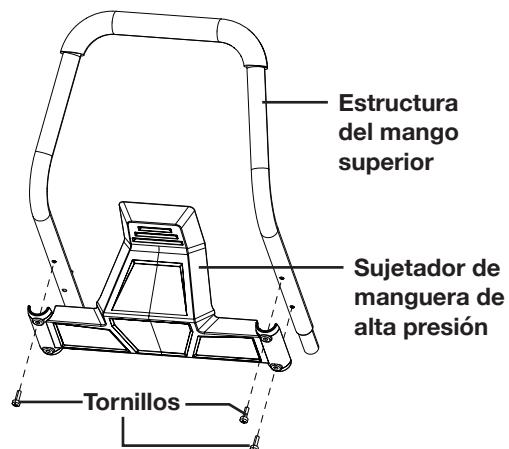
4. Conecte el sujetador de la pistola a la estructura de mango superior usando la tuerca y perno suministrados, tal como se muestra. Ajústelos de forma segura (Fig. 3).
