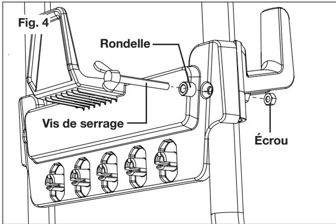
6. À l'arrière droit du cadre supérieur de guidon, placez le porte-pistolet et alignez les trous (Fig. 5). Attachez l'autre ensemble à l'aide de la vis de serrage, la rondelle et l'écrou (Fig. 6).
