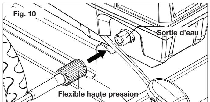
**⚠️ AVERTISSEMENT!** Maintenir le flexible haute pression à l'écart des objets tranchants. Un flexible haute pression qui éclate peut causer des blessures. Examiner régulièrement le flexible haute pression et le remplacer s'il est endommagé. Ne pas essayer de réparer un flexible haute pression endommagé.
