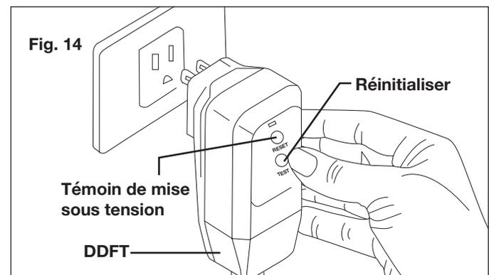
**REMARQUE** : il se peut que le DDFT nécessite d'être d'abord branché dans la prise électrique. Appuyez sur le bouton « Reset » (Réinitialiser) jusqu'à ce que le voyant de mise sous tension sur le DDFT s'allume quand la machine est branchée.
