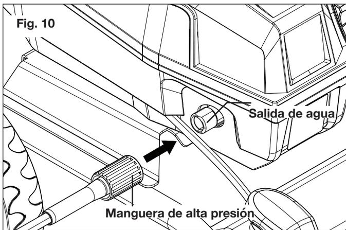
**⚠ ¡ADVERTENCIA!** Mantenga la manguera alejada de objetos afilados. Una manguera que reviente puede causar lesiones personales. Examine las mangueras regularmente y reemplácelas si están dañadas. No intente reparar una manguera dañada.
