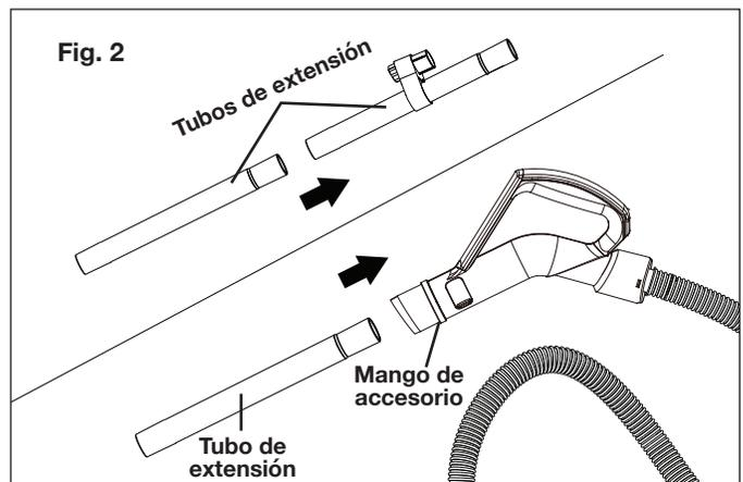
3. Seleccione el accesorio deseado, conéctelo al extremo del tubo de extensión, y presiónelo firmemente para trabarlo de forma segura. Su aspiradora en seco/mojado ya está lista para ser usada. Si no necesita una extensión, conecte el accesorio deseado directamente al mango del accesorio (Fig. 3).
