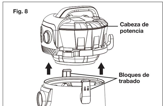
2. Para volver a conectar la cabeza de potencia, instálela sobre el tanque y apriete los bloques de trabado.
