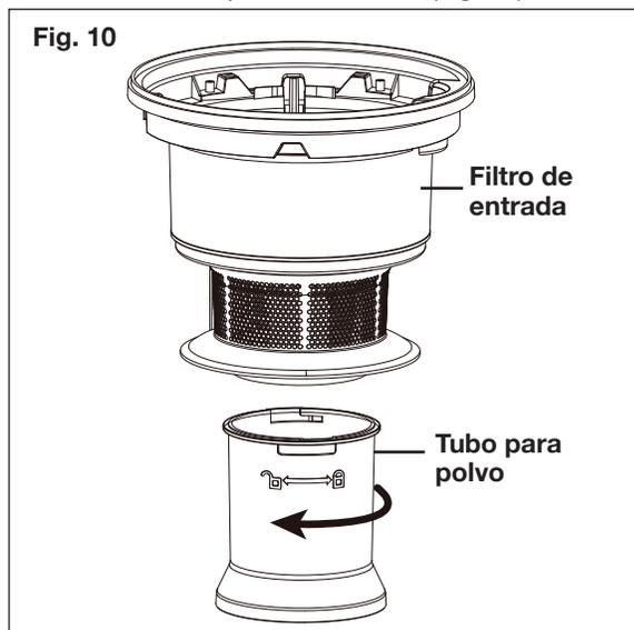
5. Use un jabón suave en una solución de agua para lavar todos los componentes de la carcasa, y enjuáguelos con agua limpia. Permita que los filtros y carcasa se sequen al aire durante 24 horas antes de volver a instalarlos.
