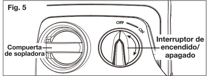
6. Para detener la unidad, mueva el interruptor de encendido/apagado a la posición de apagado "OFF" tal como se indica (Fig. 5).
