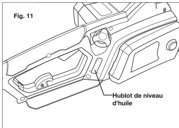
**REMARQUE :** votre scie à chaîne électrique est équipée d'une pompe à huile automatique pour la lubrification du guide-chaîne et de la chaîne. Vous devez ajouter de l'huile pour chaîne et guide-chaîne, sinon votre scie à chaîne ne fonctionnera pas correctement.
