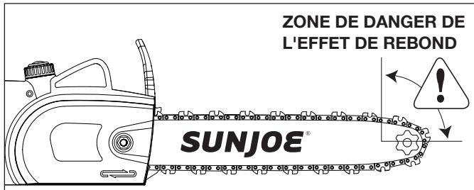
Un effet de rebond peut se produire quand le pignon de renvoi ou l'extrémité du guide-chaîne touche un objet ou quand le bois se rapproche trop près de la chaîne de la scie et la pince dans l'entaille en la retenant. Dans certains cas, le contact avec l'extrémité peut entraîner une brusque réaction inverse en faisant rebondir le guide-chaîne vers l'avant et vers l'arrière en direction de l'utilisateur.
