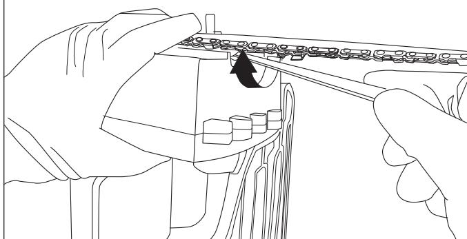
2. La tensión es correcta cuando los eslabones de impulso en la cadena no se resbalan fuera de la guía de la cadena en la barra cuando la cadena es jalada hacia arriba desde el medio de la barra (Fig. 10).
