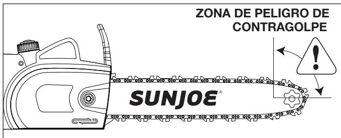
El contragolpe puede ocurrir cuando la nariz o la punta de la barra-guía tocan un objeto, o cuando la madera se cierra y aprieta la motosierra durante el corte. El contacto de la punta en algunos casos puede causar una súbita reacción en reversa, lanzando la barra-guía hacia arriba y hacia atrás, en dirección del operador.
