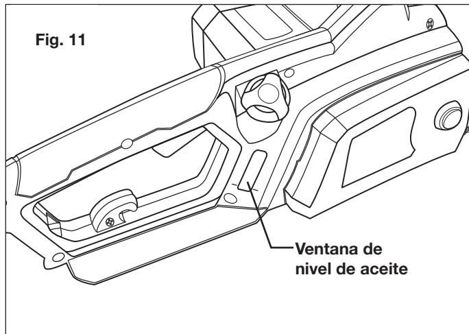
**NOTA:** su motosierra está equipada con una bomba automática de aceite para la lubricación de la barra y la cadena. Usted debe agregar aceite de barra y cadena, o su motosierra funcionará defectuosamente.
