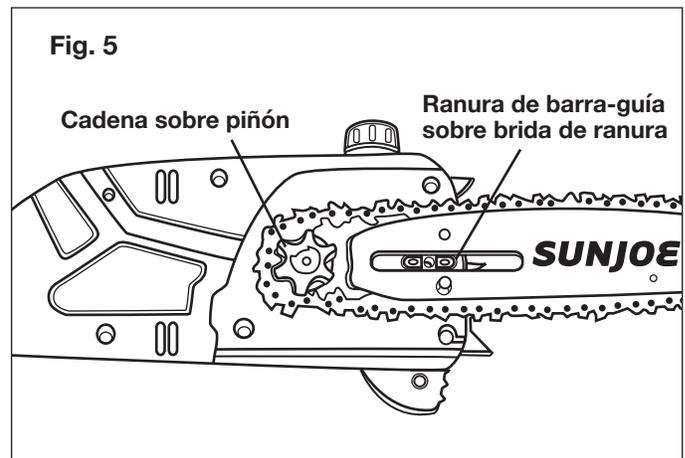
7. Coloque la barra-guía nivelada contra la superficie de montura de manera que la ranura de la barra-guía encaje en la brida de ranura en el cabezal, y sujétela firmemente en su lugar (Fig. 5).
