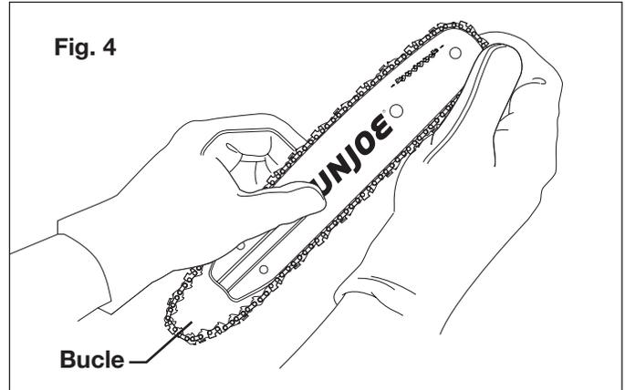
6. Posicione la cadena de manera que haya un bucle en la barra-guía. Sostenga la cadena en su lugar sobre la barra-guía y coloque el bucle alrededor del piñón (Fig. 5).
