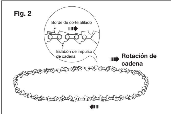
5. Empezando en la punta, monte los eslabones de impulso de la cadena en la ranura de la barra-guía, dejando un bucle en la parte posterior de la barra-guía. La cadena encajará suelta hasta que sea colocada en el piñón (Figs. 3 y 4).
