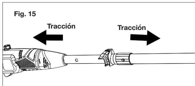
4. Trabe el tubo telescópico en su lugar cerrando el seguro de leva (Fig. 16). Compruebe que el tubo esté firmemente asegurado.
