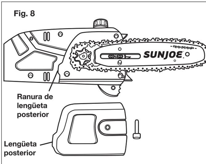
10. Instale el perno de cubierta de piñón y apriete con la mano, dándole a la barra-guía algo de movimiento libre para un futuro ajuste de tensión (Fig. 9).
