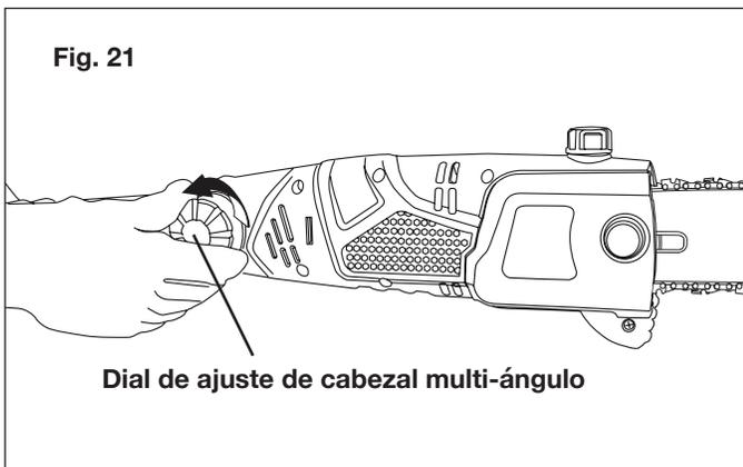
3. Ajuste el cabezal a la posición deseada (Fig. 22).
