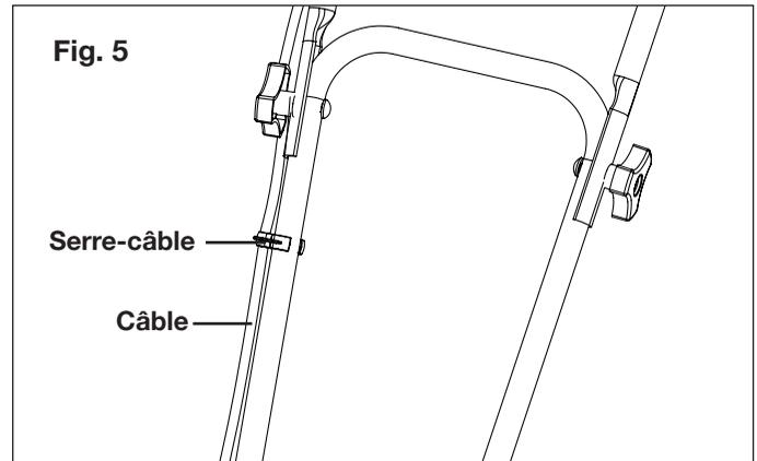
**⚠ AVERTISSEMENT!** Avant d'utiliser le rotoculteur-cultivateur électrique, s'assurer que tous les boutons d'ensembles guidon sont correctement serrés.
