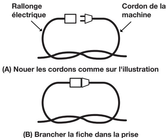
5. N'utilisez pas le cordon à mauvais escient. Ne tirez jamais le rotoculteur-cultivateur par le cordon et ne tirez pas brusquement sur le cordon pour le retirer de la prise. Maintenez le cordon éloigné de la chaleur, de l'huile et des objets tranchants.
