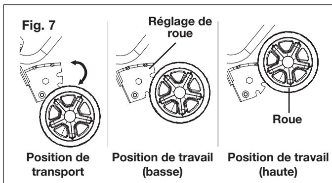
**⚠️ AVERTISSEMENT!** Toujours s'assurer que les roues sont bien attachées et verrouillées. Ne pas essayer d'utiliser la machine quand les roues ne sont pas en place et verrouillées.
