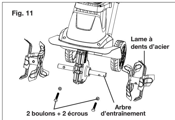
**IMPORTANT :** les dents doivent être disposées dans le bon sens de rotation. Notez le sens dans lequel les anciennes dents étaient disposées et posez les nouvelles de la même façon.
