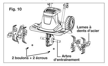
**IMPORTANT :** les dents doivent être disposées dans le bon sens de rotation. Notez le sens dans lequel les anciennes dents étaient disposées et posez les nouvelles de la même facon.
