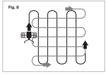
Faites particulièrement attention quand vous changez de direction. Exercez une légère pression sur le guidon pour lever les dents et faciliter les virages. Faites tourner la machine en utilisant les roues comme guide. Relâchez progressivement la pression sur le guidon et abaissez les dents sur le sol.
