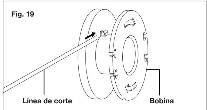
4. Doble la línea de corte 180° alrededor del orificio, asegurando la parte doblada con el pulgar de su mano izquierda, y use su mano derecha para enrollar la línea siguiendo las flechas de la bobina (Fig. 20). Use una ligera tensión para asegurarse de que la línea esté tensionada alrededor de la bobina.
