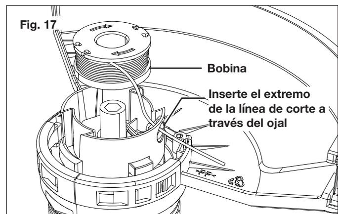
4. Inserte la bobina dentro de la máquina y presiónela firmemente hasta que haga “clic” en su lugar. Ajuste el largo de la línea de corte fuera jalándola para alargarla o rotando la bobina en sentido antihorario para acortarla. Vuelva a colocar la cubierta de bobina de forma segura para trabar el ensamblado (Fig. 18).
