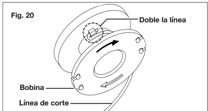
5. Reinstale la bobina según lo indicado en los pasos 3 y 4 de “Reemplazo de la bobina y despeje de obstrucciones y líneas enredadas”.
