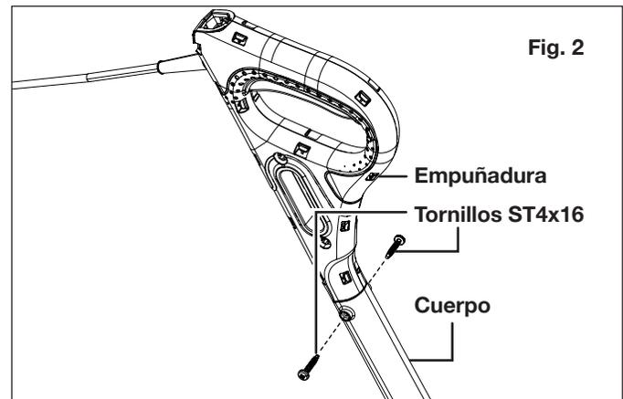
2. Alinee la lengüeta redonda, con la flecha en el lado derecho del cabezal, con la ranura en el lado derecho del extremo inferior del cuerpo. Luego inserte el cabezal dentro del cuerpo hasta que se trabe en su lugar. Asegure las dos partes con los dos tornillos ST4x16 incluidos (Figs. 3 y 4).
