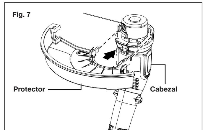
2. Asegure el protector sobre el cabezal de la podadora de césped eléctrica empleando el tornillo de rosca parcial ST4 x 18 suministrado (Fig. 8).
