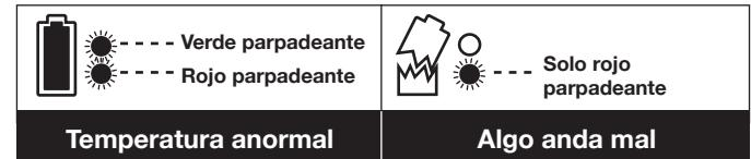
6. Una batería descargada por completo, con una temperatura interna en el rango normal se cargará por completo dentro de 3 horas (a una temperatura de entre 32°F [0 °C] y 113°F [45°C]). Las baterías cargadas y descargadas con mucha frecuencia pueden demorarse más en cargarse por completo.
