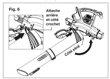
**4.** Insérez le raccord de sac de ramassage dans la sortie d'air du souffleur jusqu'à ce que le sac de ramassage soit solidement attaché (Fig. 7), puis utilisez l'attache-sac.
