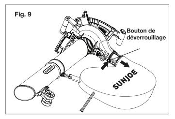
Pour retirer l'ensemble buse d'aspiration/broyage, faites glisser le bouton de verrouillage d'obturateur d'arrivée d'air pour le déverrouiller, puis retirez l'ensemble buse du caisson moteur (Fig. 10).
