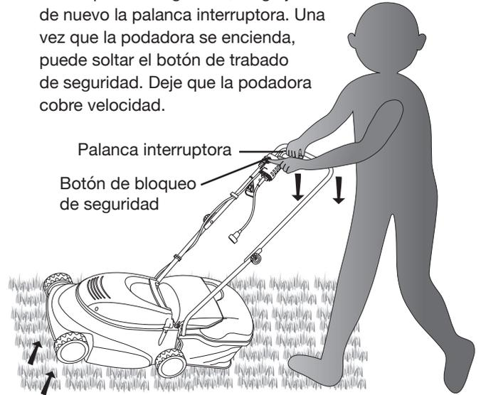
**Paso 3:** lentamente baje la podadora de manera que las ruedas frontales estén sobre el piso y empiece a podar.
