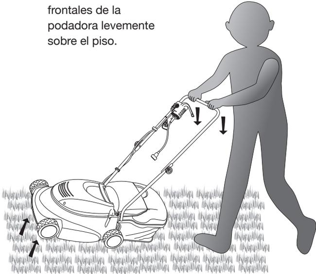
**Paso 2:** presione hacia abajo y sujete el botón de bloqueo de seguridad, luego jale de nuevo la palanca interruptora. Una vez que la podadora se encienda, puede soltar el botón de trabado de seguridad. Deje que la podadora cobre velocidad.
